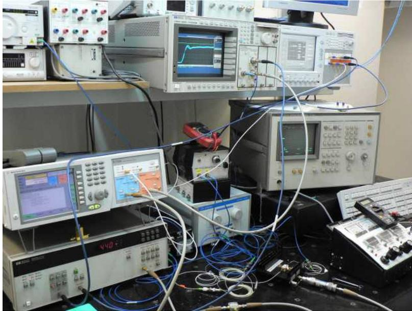
Figura 4.1: Foto da montagem experimental usada para testar diversos tipos de sinais de chaveamento no SOA InPhenix.
