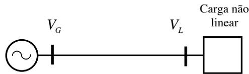
Figura 3-13 – Rede de distribuição simples com carga não linear.
