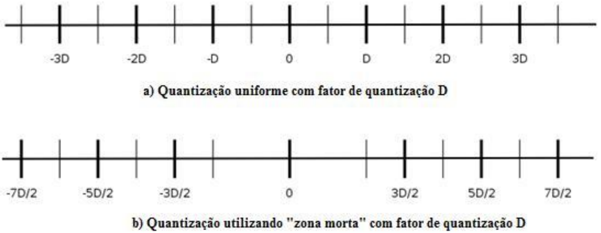
Figura 4.4: (a) Quantização uniforme. (b) Quantização utilizando "zona morta", utilizada pelo Dirac (42).
