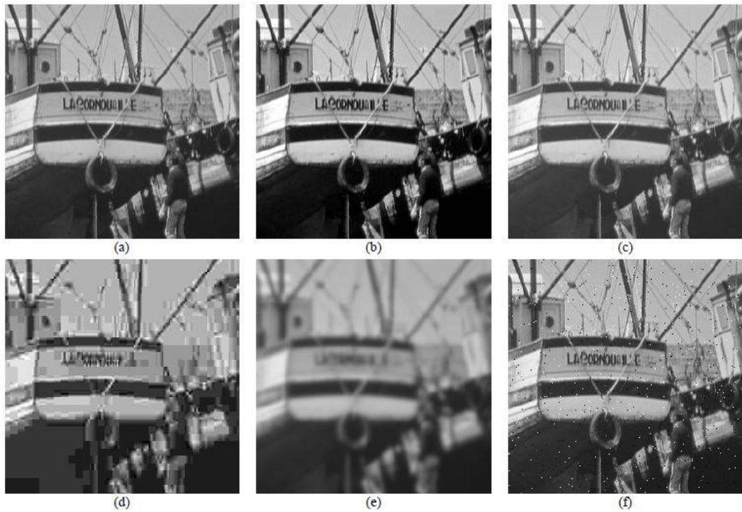
Figura 2.3: Comparação de imagens com diferentes tipos de distorção, todas com MSE = 210 (mesmo PSNR). (a) original. (b) com aumento de contraste, MSSIM = 0,9168. (c) com média deslocada, MSSIM = 0,9900. (d) comprimida com JPEG, MSSIM = 0,6949. (e) imagem borrada, MSSIM = 0,7052. (f) com ruído impulsivo "salt-pepper", MSSIM = 0,7748 (32).
