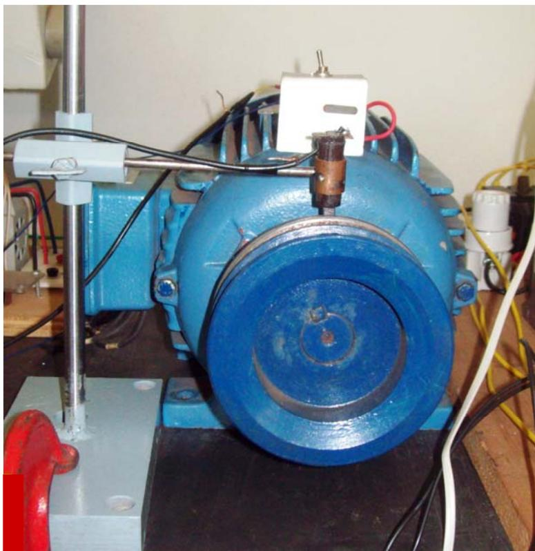
Fig. A3: Sistema anel-escôva e chave para curto-circuitar o eixo e os rolamentos
