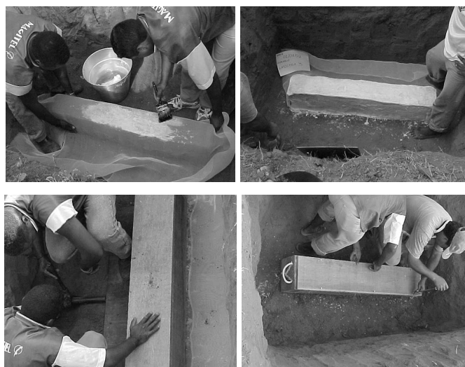
Figura 3.2.2. 1 - Etapas da coleta de uma amostra de solo para medição em bancada (fotos: Amostra 3, Cachoeira Paulista, 01/08/2002)
