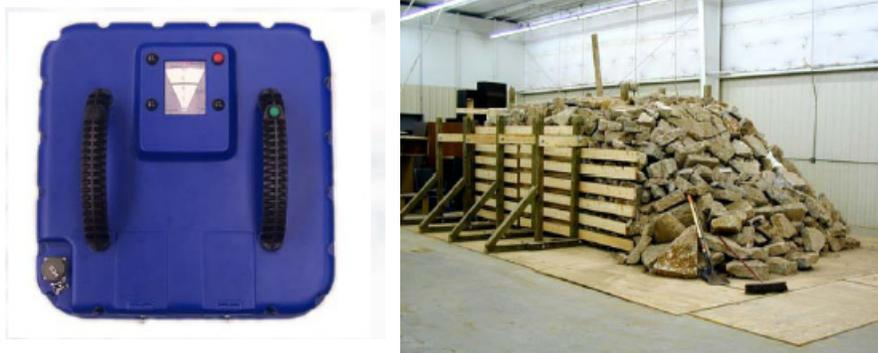
FIG. 1.17: RADAR DE RESGATE RUBBLE VISION™ E SEU LOCAL DE TESTES.
