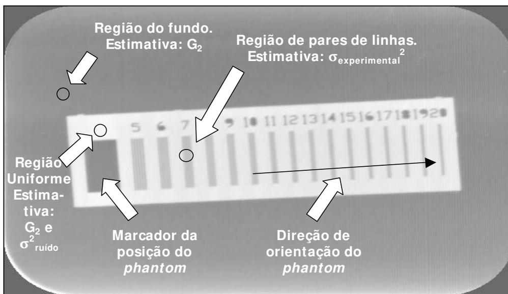
Figura 44 – Regiões do *phantom* de barras.
