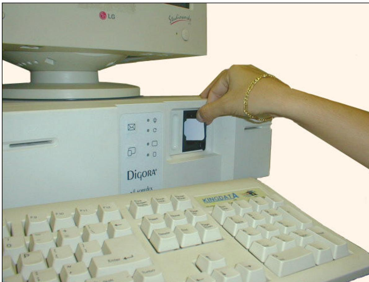
**Figura 37** – Imagem fotográfica da leitora a *laser* do sistema Digora.
