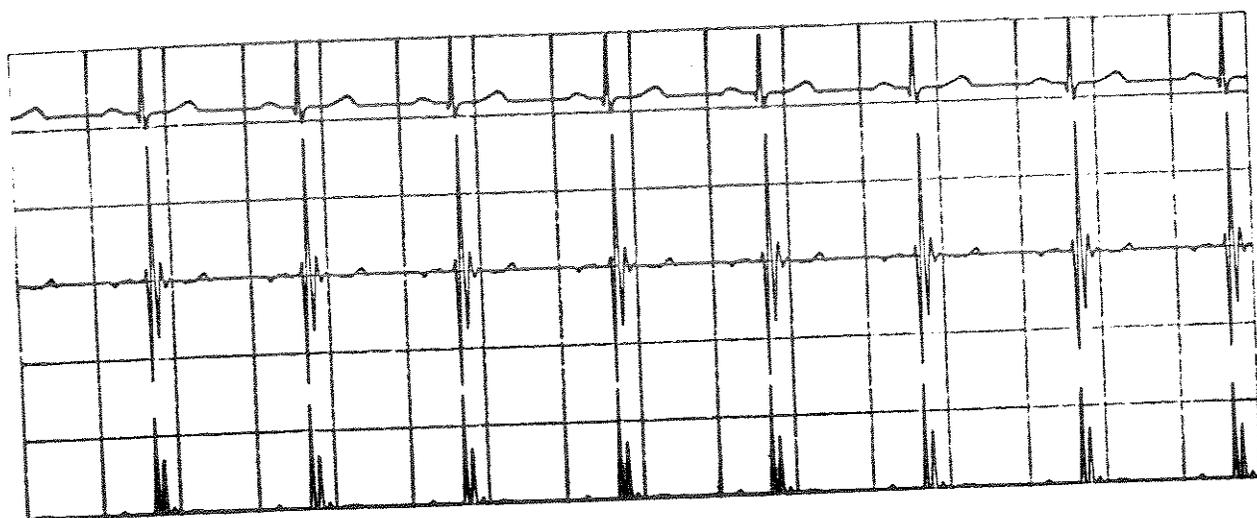
fig. A.2.2.2 - O ECG, e o mesmo filtrado por um filtro passa-faixas com  $F_c=17$  Hz, e  $Q=4$ , e o sinal retificado
