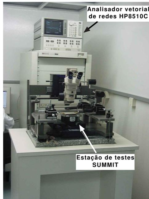
Figura 5.12 - Equipamento utilizado para a caracterização dos dispositivos em alumina e Si.
