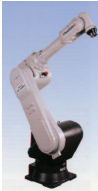
Figura 1.1: Manipulador robótico com configuração articulada do tipo cotovelo.
