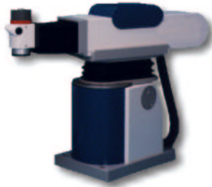
Figura 1.11: Manipulador robótico com configuração cilíndrica.
