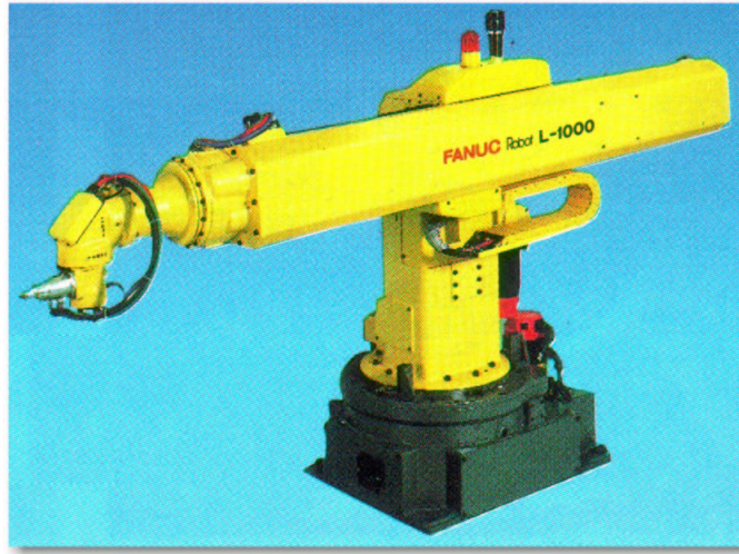
Figura 1.7: Manipulador robótico com configuração esférica.
