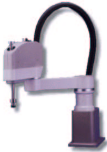
Figura 1.9: Manipulador robótico com configuração scara.
