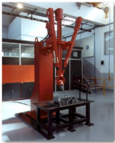
Figura 1.15: Manipulador robótico com configuração paralela.
