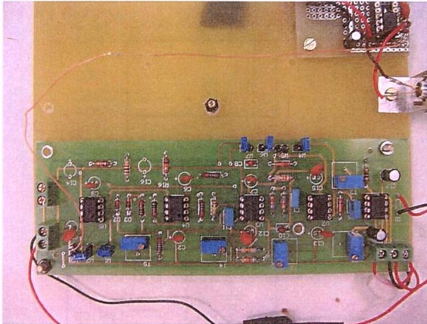
Fig. 3.5: Primeira placa projetada para desenvolvimento do receptor.
