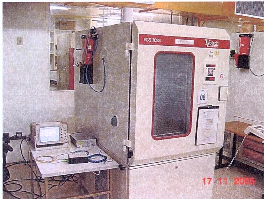
Fig. 4.11: Setup do ensaio de temperatura na grade de Bragg.
