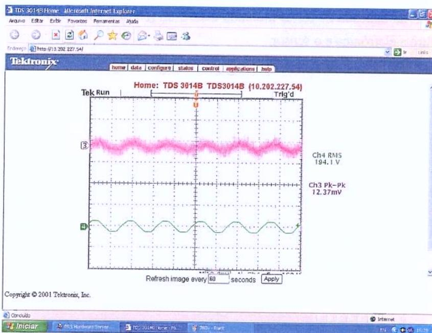
Fig. 4.3: Forma de onda do sensor para 190v.
