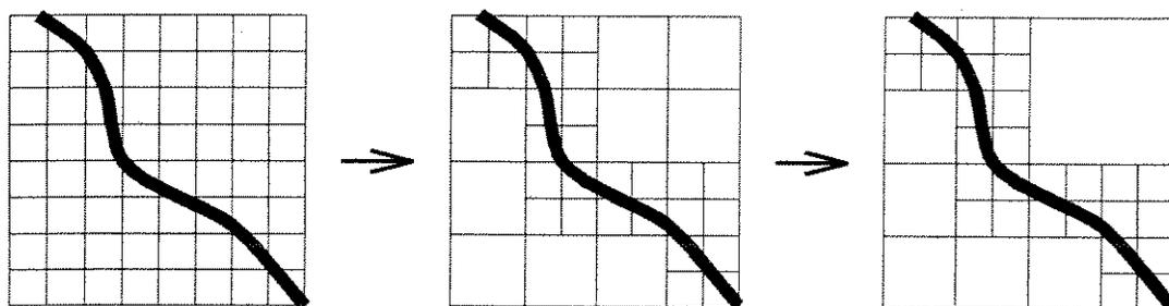
Figura 4.40: Segmentação de tamanho de bloco por junção ou união de quatro sub-blocos adjacentes.
