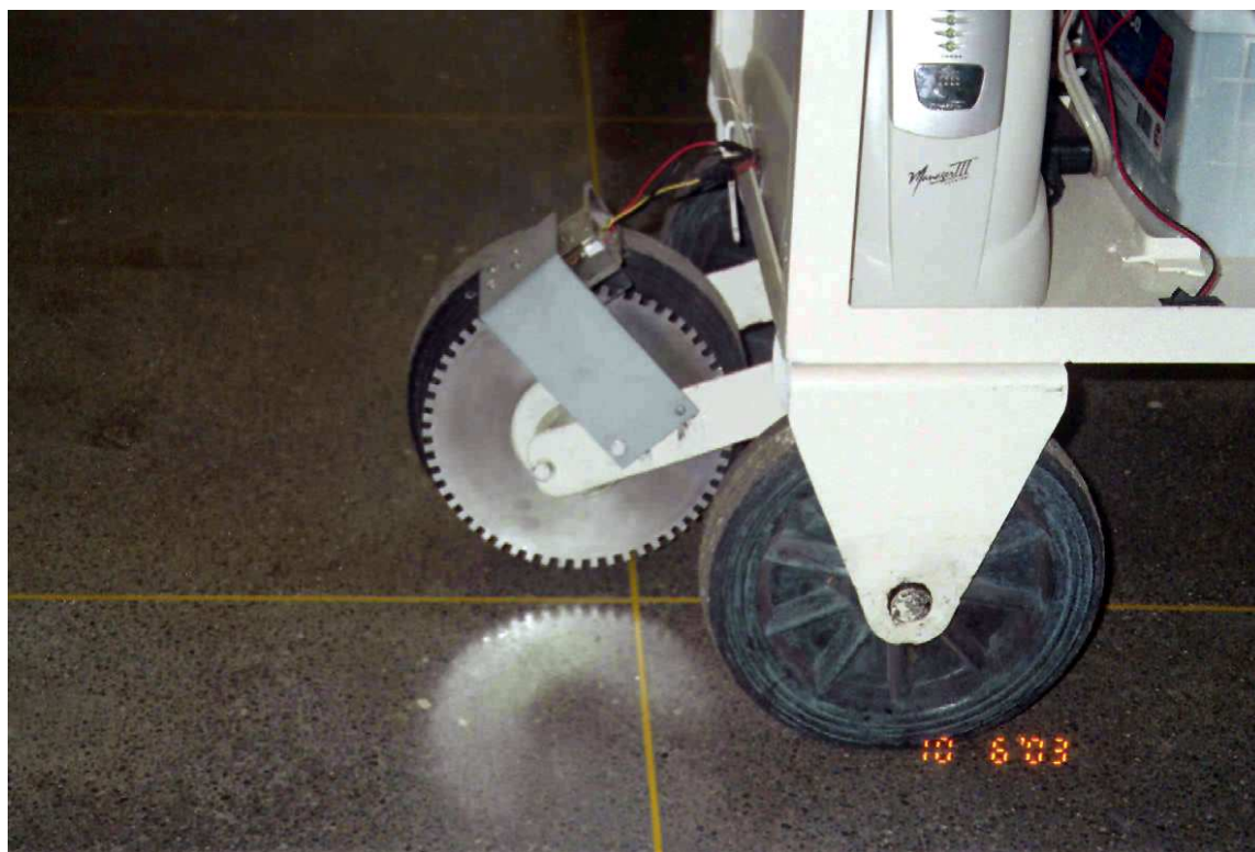
Fig. 3.3: Detalhe do amostrador espacial (roda dentada + circuito).
