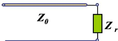
Fig. A.1: Coeficiente de reflexão
