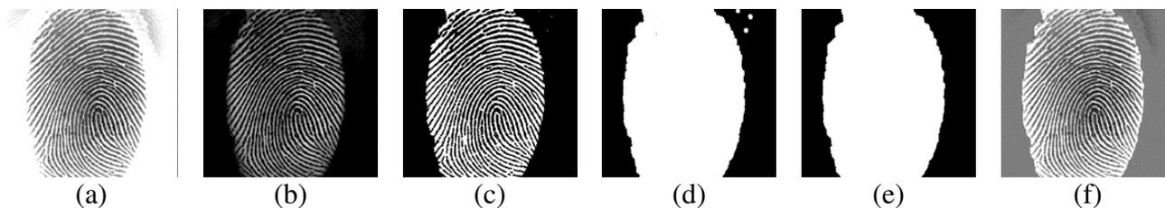
**Figura 5.** Etapas do processo de segmentação morfológica: (a) Imagem de entrada; (b) Abertura Top-Hat; (c) Binarização; (d) Dilatação; (e) Fechamento de furos e abertura; e (f) Máscara sobreposta à imagem.
