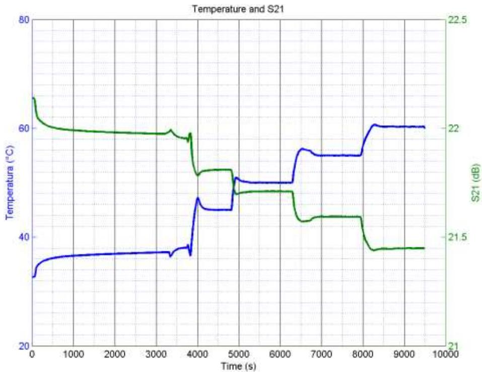
**Figura 6-13** – Dependência do ganho da eletrônica e temperatura em função do tempo.
