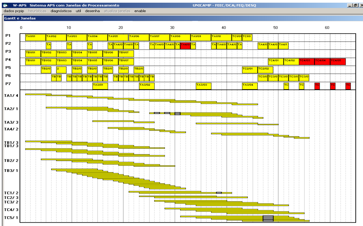
Figura 3.20: Alocações e janelas de processamento do exemplo 1 utilizando a heurística de alocação APS Relógio para a ordem de prioridades ProDA , ProDB e ProDC .
