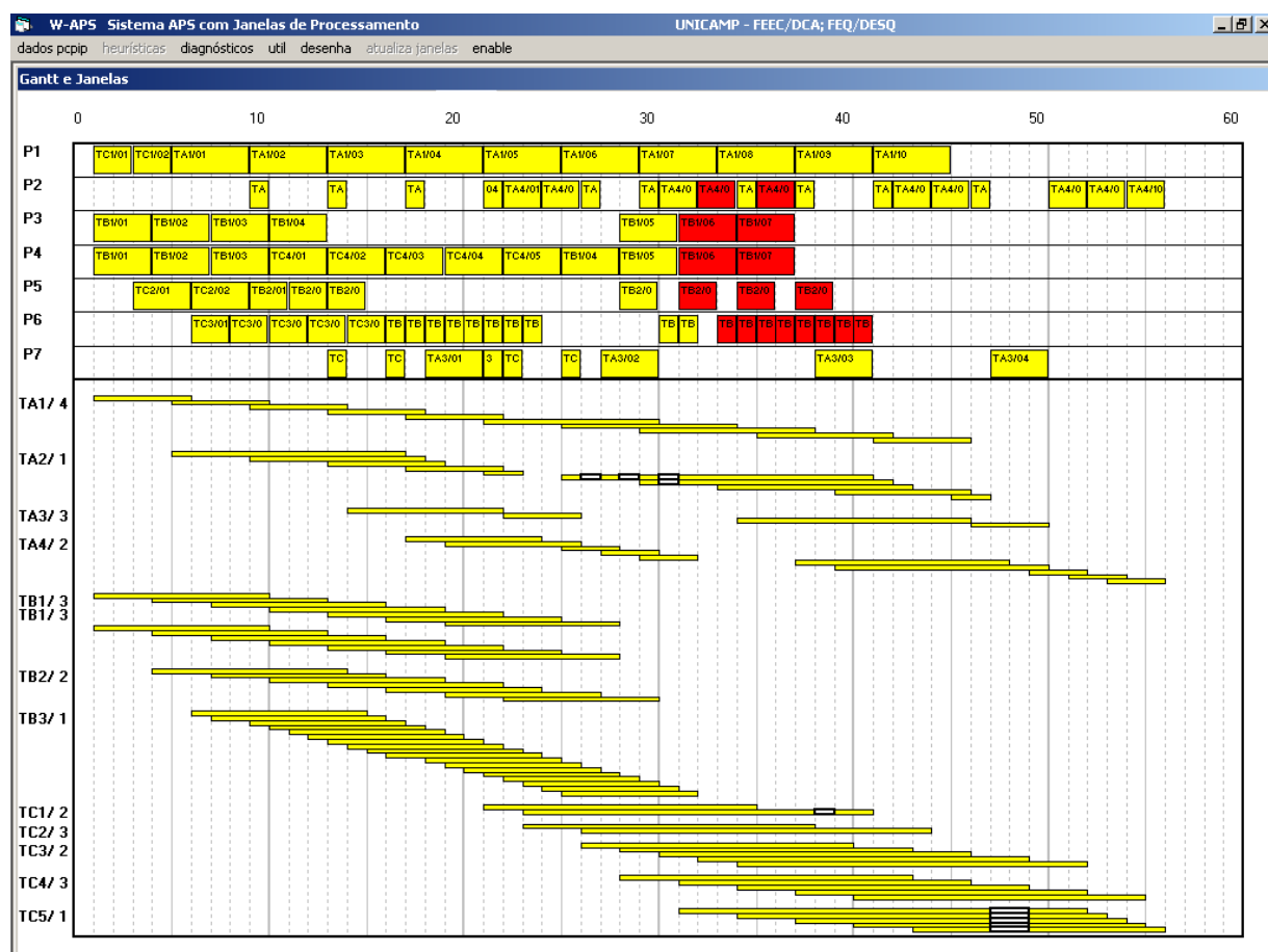
Figura 3.22: Alocações e janelas de processamento do exemplo 1 utilizando a heurística de alocação APS Relógio para a ordem de prioridades ProdC , ProdA e ProdB .
