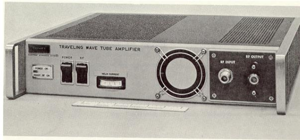
Fig. 3.4 Válvula que amplifica o sinal na faixa de 4 a 10,5 GHz.
