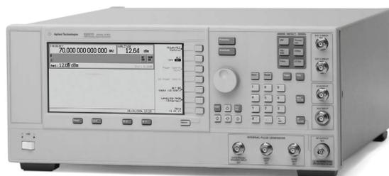
**Fig. 3.16** Gerador de sinal analógico Agilent E8257D.
