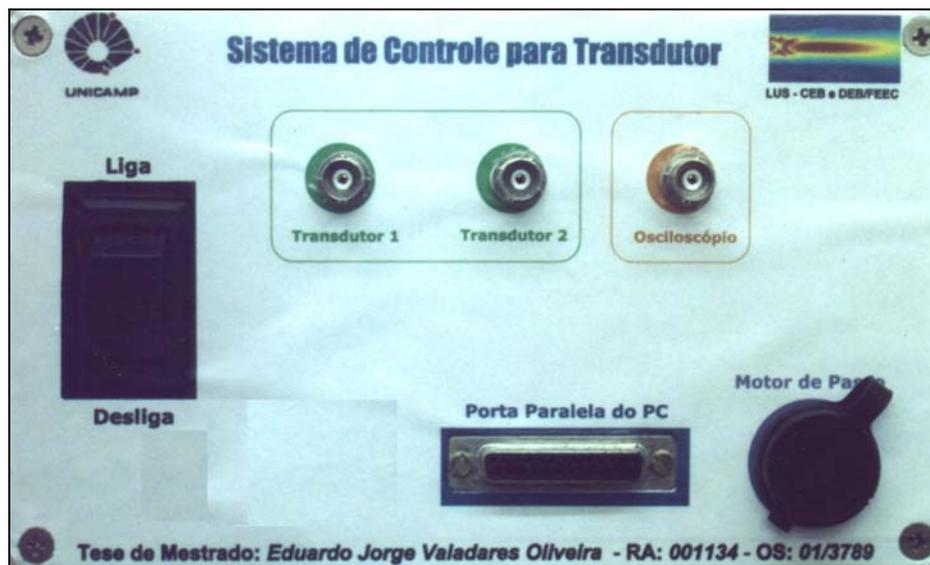
Figura 3.8: Foto do painel frontal do sistema de Controle do velocímetro Doppler desenvolvido.
