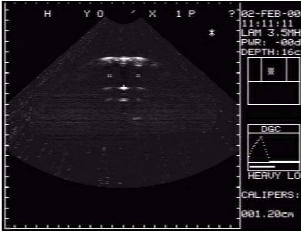
Figura 4.14: Medição do diâmetro maior do tubo de silicone. O valor obtido com a ferramenta de medição de distância do scanner encontra-se no canto inferior direito da figura.
