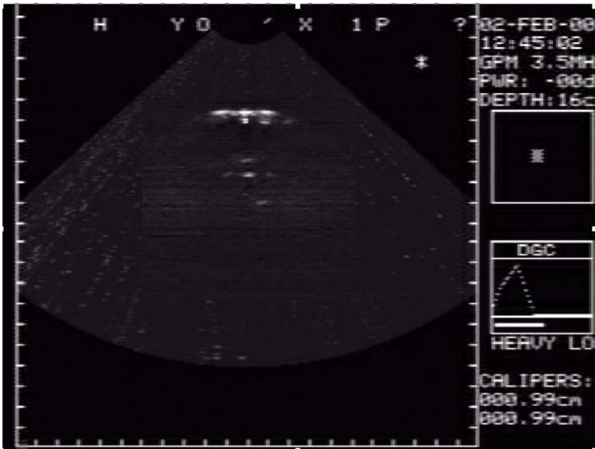
Figura 4.5: Medidas do diâmetro (indicada no canto inferior direito das figura) do tubo de silicone realizadas com o tubo posicionado a 52° em relação ao eixo central do transdutor.
