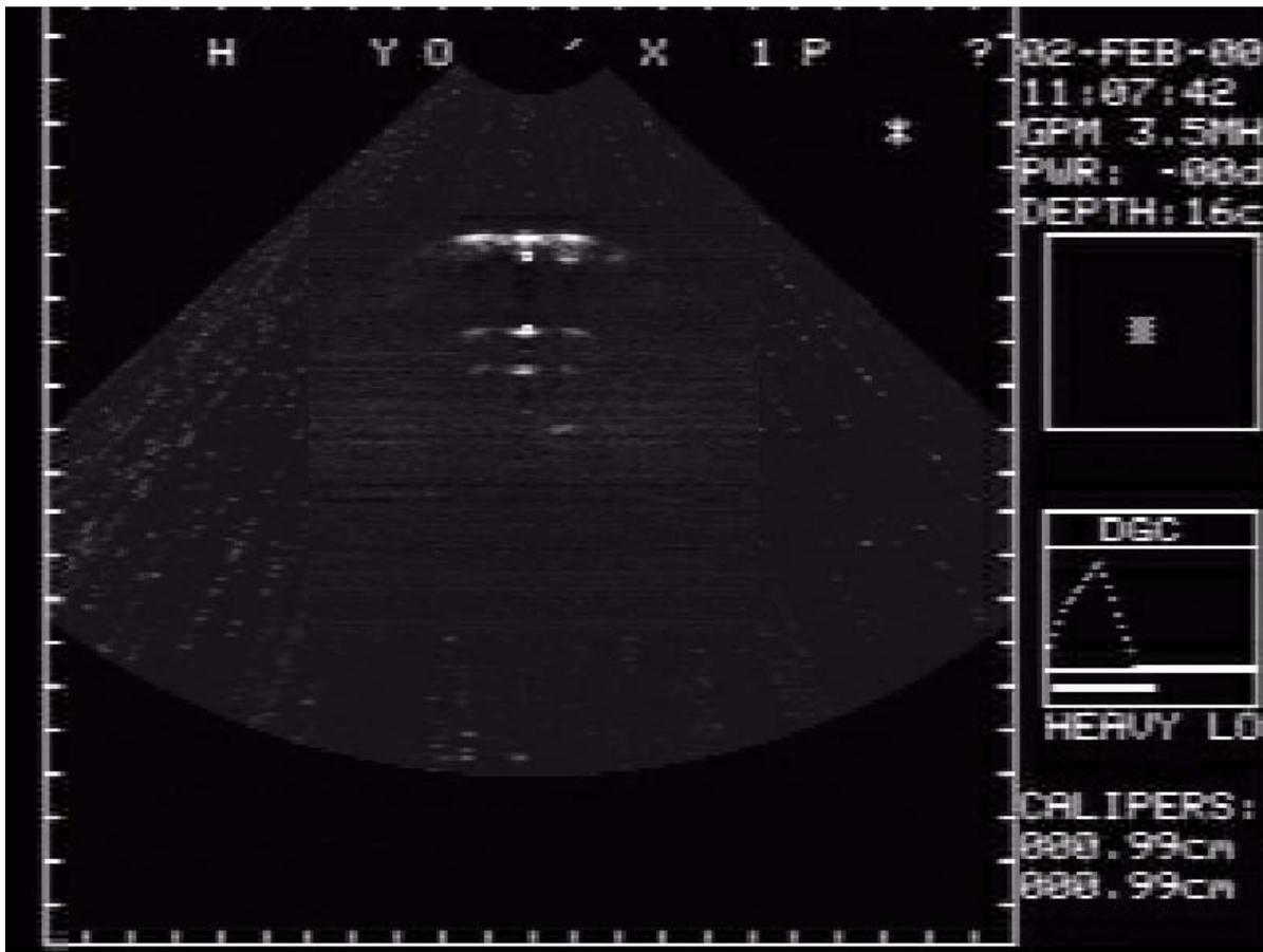
Figura 4.4: Medida do diâmetro (indicadas no canto inferior direito das figuras) do tubo de silicone realizadas com o tubo posicionado a 90° em relação ao eixo central do transdutor.
