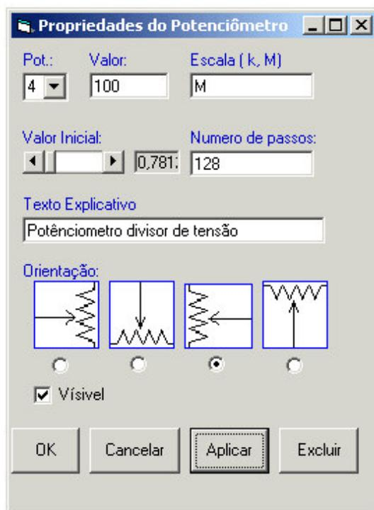
Figura 4.56 - Janela de propriedades do potenciômetro digital
