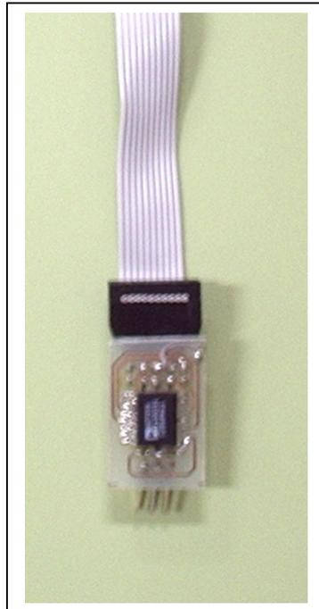
**Figura 3.49 - Bloco Eletrônico Potenciômetro Digital**
