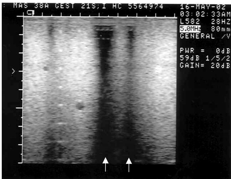
**Figura 25.** Imagem com presença de bandas verticais, indicadas pelas setas, obtida com um scanner a partir de phantom (Multipurpose Tissue/cyst Phantom da Nuclear Associates).
