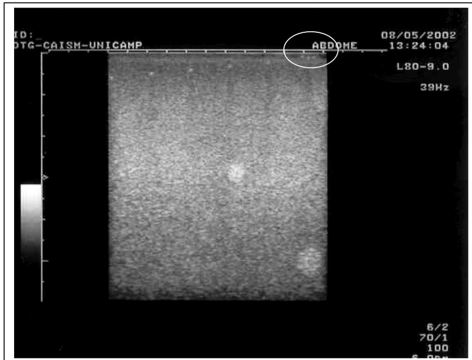
**Figura 30.** Teste de zona morta realizado através da imagem de um Multipurpose Tissue/cyst Phantom da Nuclear Associates. O círculo mostra os primeiros alvos visualizados, os quais indicam a zona morta do transdutor avaliado.
