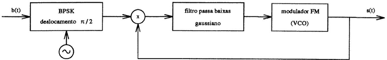
Figura 3.5: Modulador GMSK - tipo PLL.
