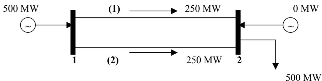
**Figura 5. Solução do Fluxo de Potência Ótimo (FPO).**
