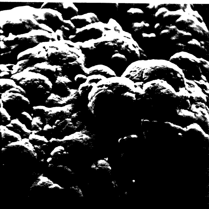
Fig. 16 Micrografias por MEV de UTEC 3540 1050X (esquerda) e Gur 413 2600X (direita), mostrando a composição das superfícies a partir de microesferas, porém e tamanhos diferentes entre os dois materiais
