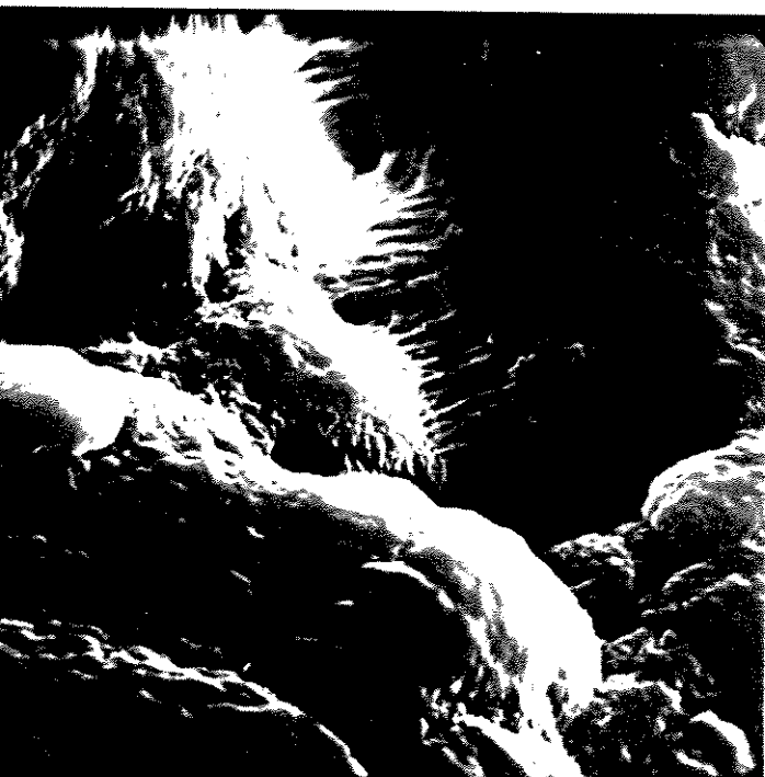
Fig. 17 Micrografias por MEV de UTEC 3540 15000X (esquerda) e Gur 413 18000X (direita), mostrando as microfibrilas que interligam as microesferas, nos dois materiais
