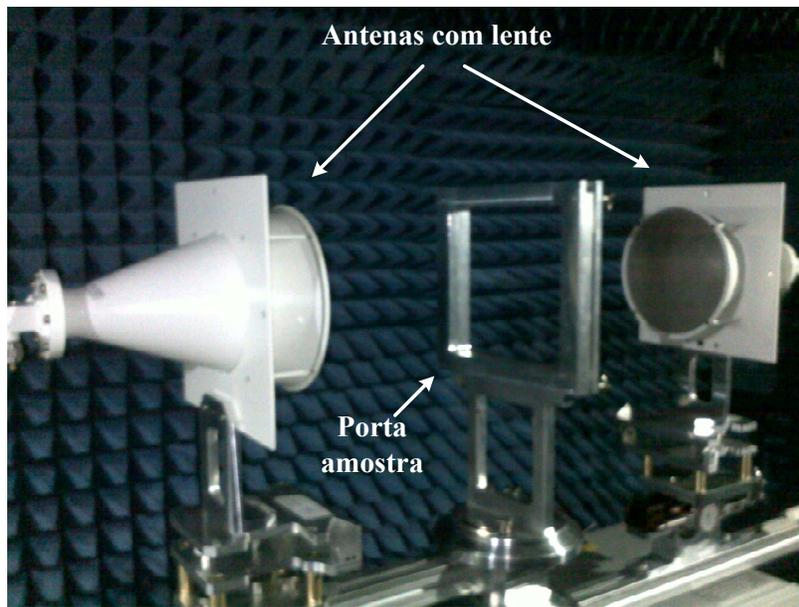
Figura B.2: Fotografia do *setup* de teste de medida em espaço livre usando antenas com lentes colimadoras.
