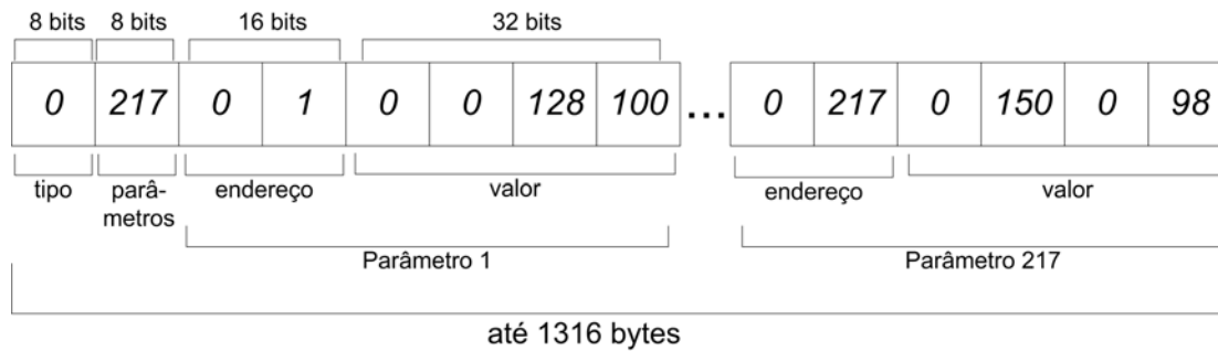
Fig. 5.8: Estrutura do pacote de monitoração definido no protocolo MCP.
