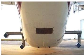
Figura 1.1 Configuração das antenas da banda X (sistema OrbiSAR).
