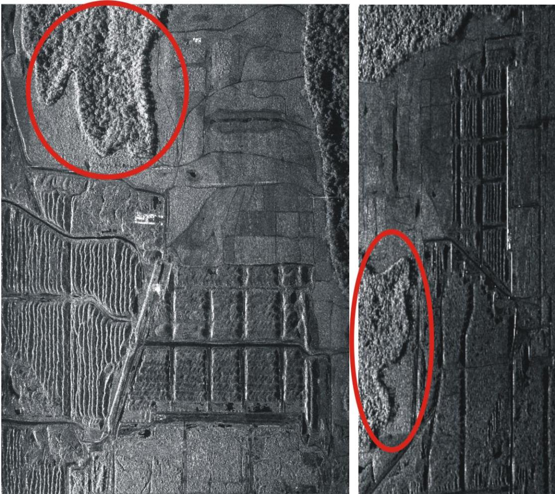
Figura 4.3 – Imagens amplitude, em linha de visada, das faixas transversais esquerda). Faixa 1 com espaçamento entre pixels de 0.375 metros; direita), Faixa 2 com espaçamento entre pixels de 1,5 metros.
