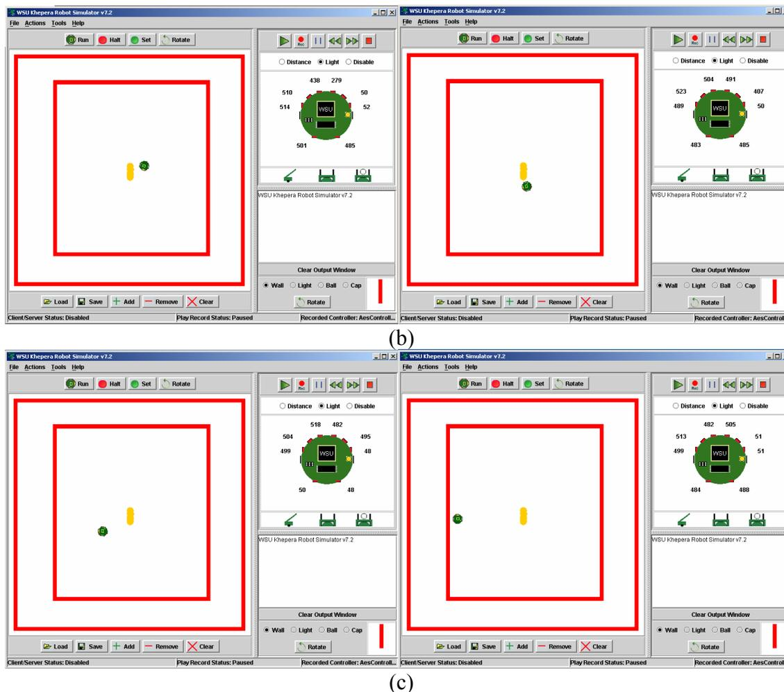
**Figura 6.17 – Experimento II: seqüência de passos do robô (a), (b) e (c) (da esquerda para a direita) juntamente com leitura dos sensores de luz. O robô se move do canto direito em direção à fonte de luz no centro da arena e depois de volta à parede. O ponto da parede (limite do ambiente de navegação) que é atingido pelo robô é arbitrário.**
