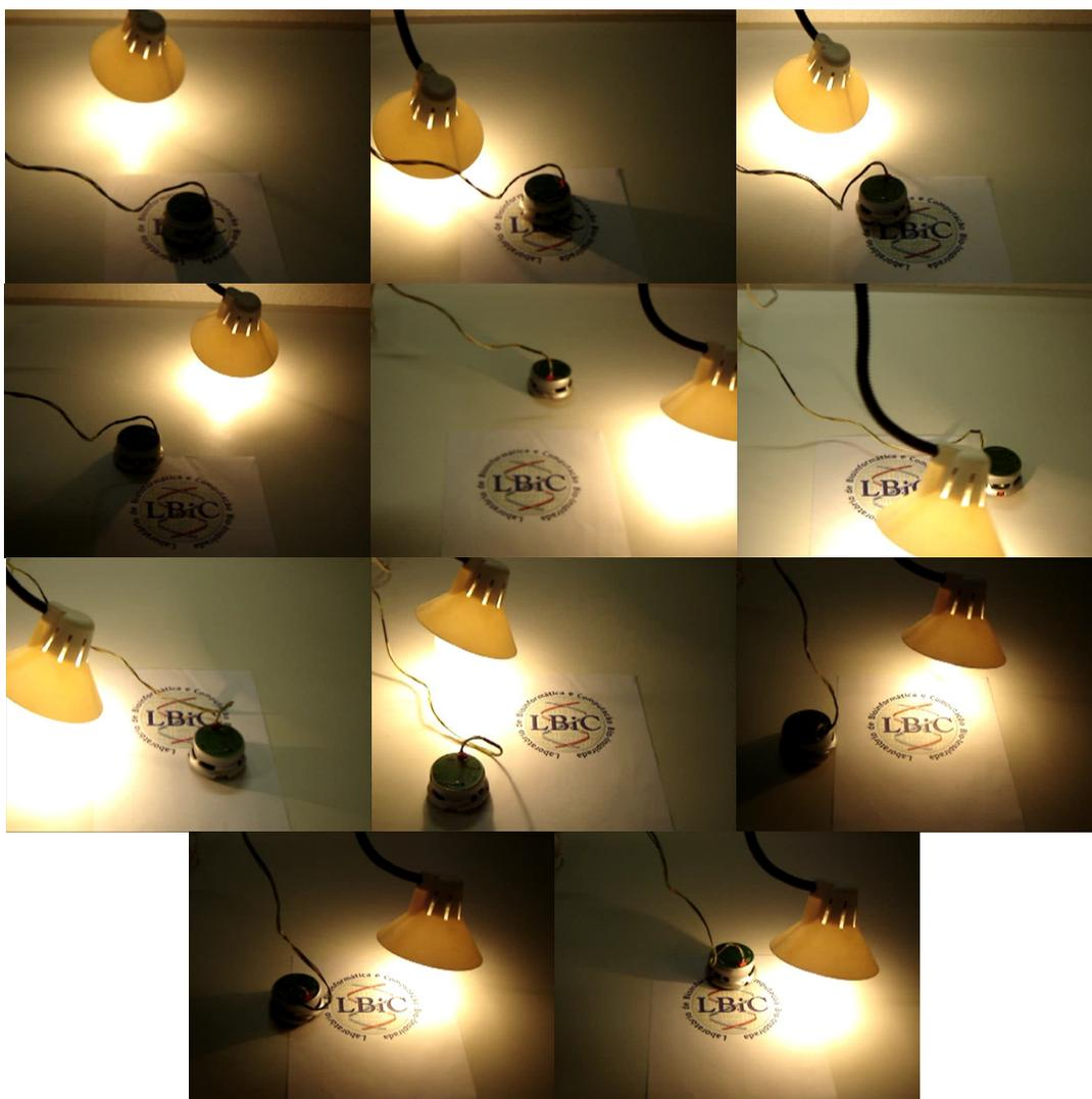
Figura 6.25 - Experimento IV, Etapa 2 – Seqüência de movimentos do robô seguindo uma fonte de luz que se move.
