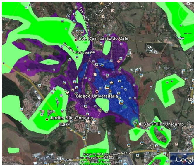
Fig. 3.14 Sobreposição de sinal devido ao transmissor principal e o Gap-Filler
