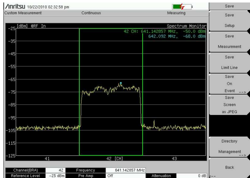
Figura 3.20 Nível do sinal com atuação do Gap-Filler
