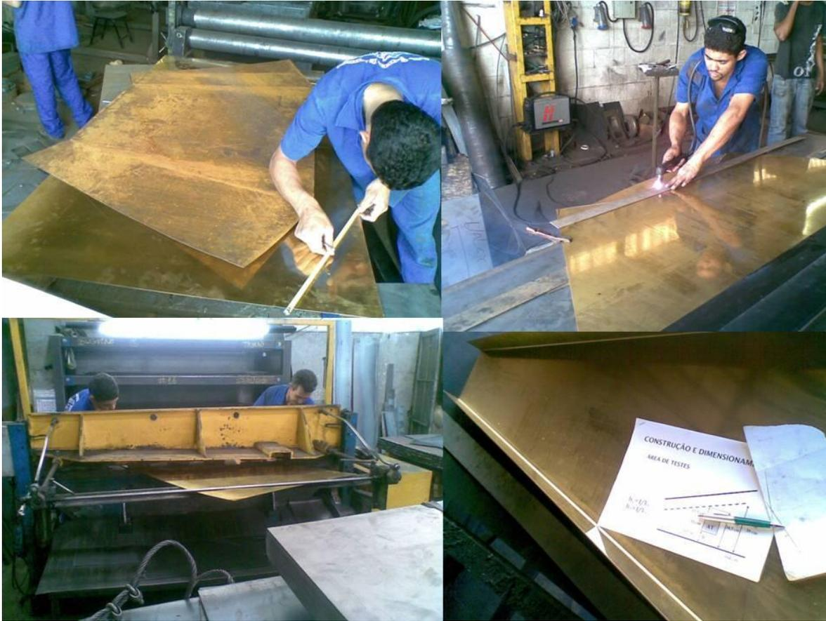
Figura 5.1: Processo de corte e dobra das chapas de latão- do alto no sentido horário: marcação da chapa de latão de acordo com projeto; corte da parte frontal do setor 2 com plasma; dobra da chapa; primeira metade do setor 2 finalizada.
