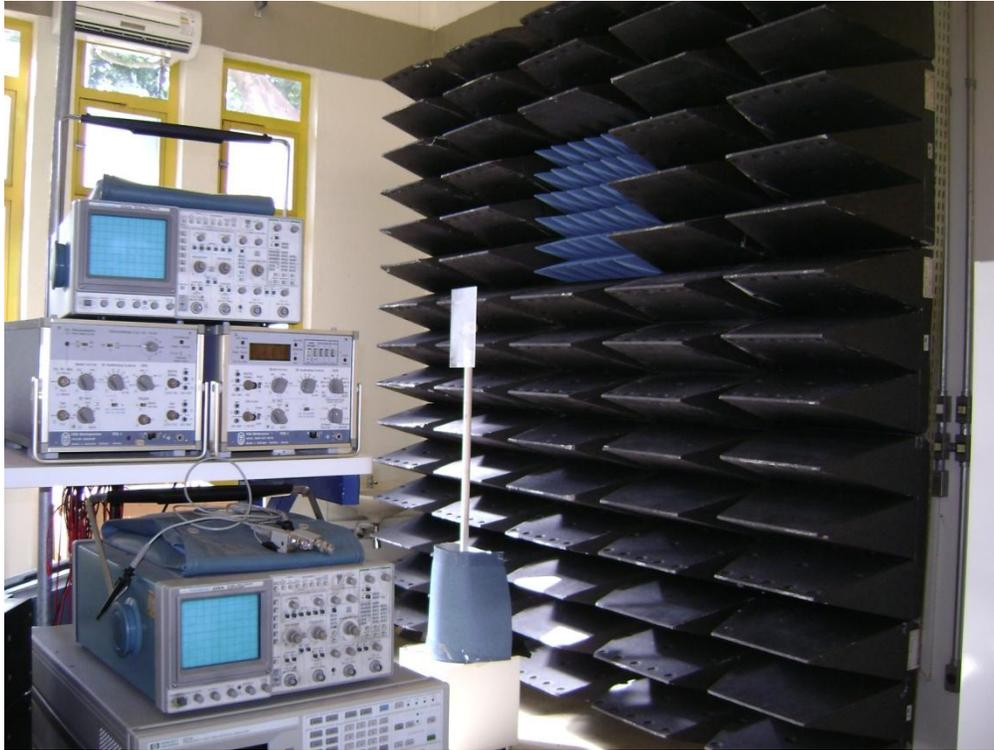
Figura 2.6: Parede com absorvedores para compor setup OATS.
