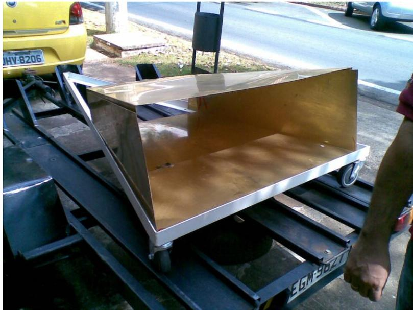
Figura B.2: Seção 3 da GTEM dobrada.
