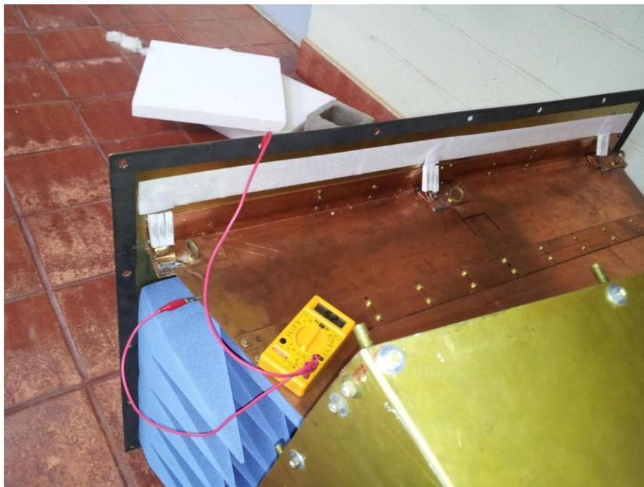
Figura B.5: Detalhe da terminação de 50 Ohms.
