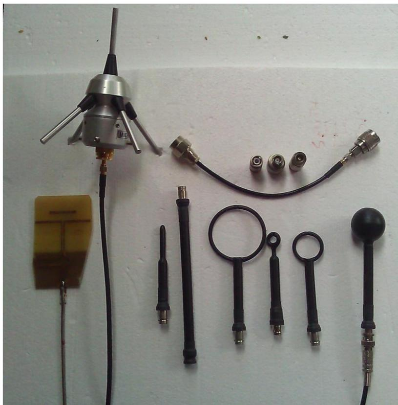
Figura 5.6: *Probes* elétricos e magnéticos EE-6992.
