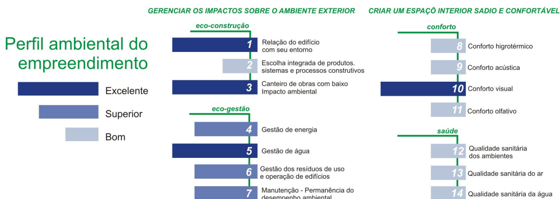
Figura 6.6 – Exemplo genérico de apresentação dos resultados da certificação AQUA por meio de um perfil ambiental do empreendimento (FCAV, 2007).
