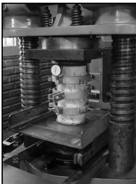
**Figura 4. 6 – Corpo-de-prova submetido ao ensaio de módulo de deformação.**
