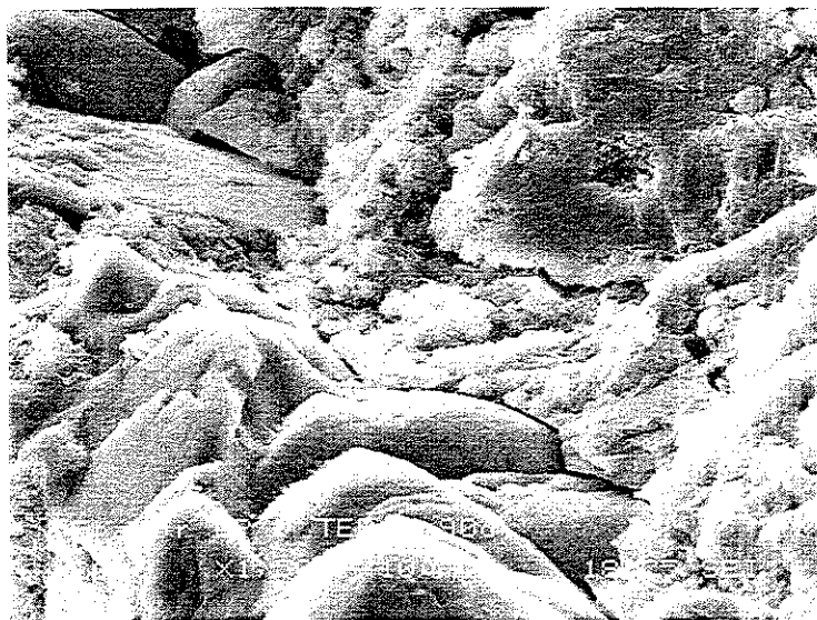
Figura 5.59 – Micrografia 1 – C-S-H do tipo IV, presente em uma zona de transição de uma amostra de concreto de CP V-ARI e cura térmica a 60 °C com 90 dias de idade.
