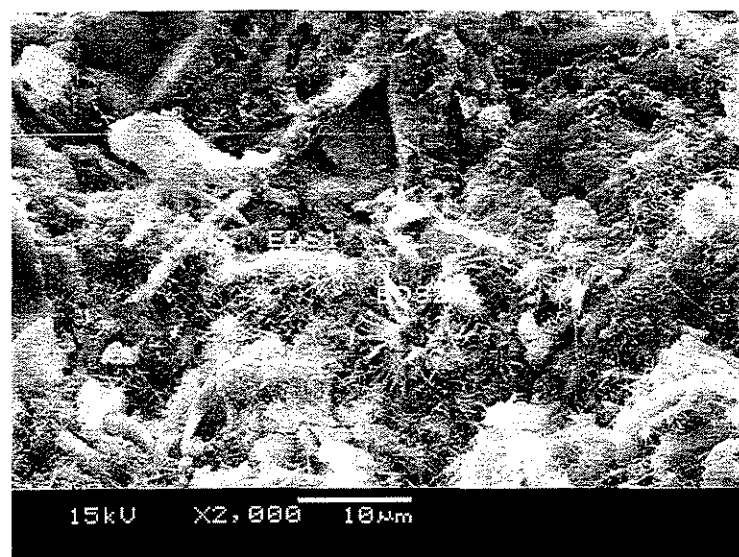
Figura 5.71 – Micrografia 13 – Fase C-A-H formada ao redor dos grãos em amostra de concreto de CP III e curada termicamente a 60 °C após 24 horas.
