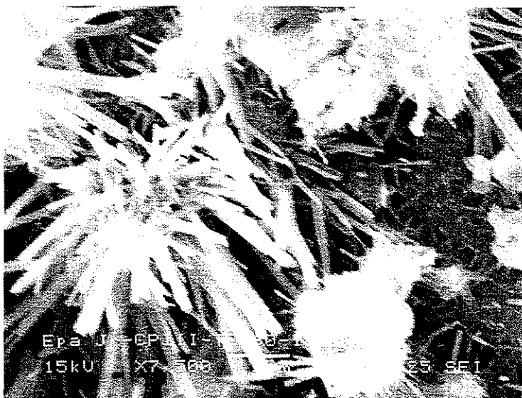
Figura 5.66 – Micrografia 8 – Presença de agulhas de etringita em vazios em uma amostra de concreto de CP III e cura térmica a 60 °C após 180 dias.
