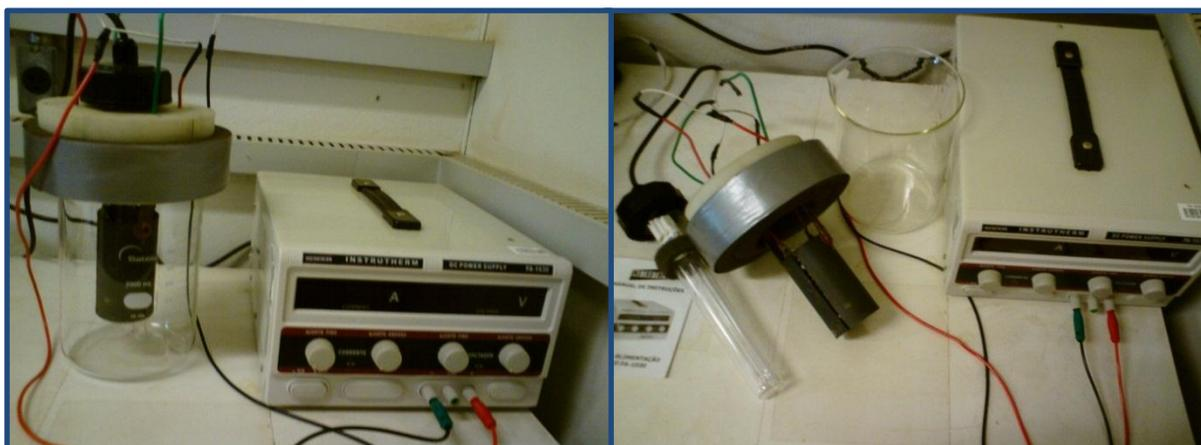
**Figura 8.** Imagem do reator eletroquímico/fotoeletroquímico utilizado para os testes de degradação de ivermectina em solução aquosa. À esquerda: visão completa do sistema; à direita: partes constituintes do reator.
