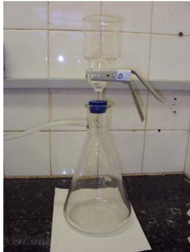
Figura 03: Suporte para filtração
