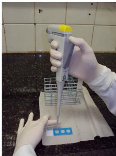
Figura 06: Transferência de alíquota de 5  $\mu$ L de amostra para poço da lâmina
