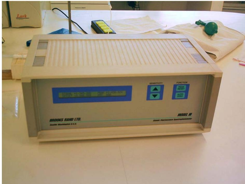
Figura 15: Espectrômetro de fluorescência atômica do vapor frio de mercúrio.
