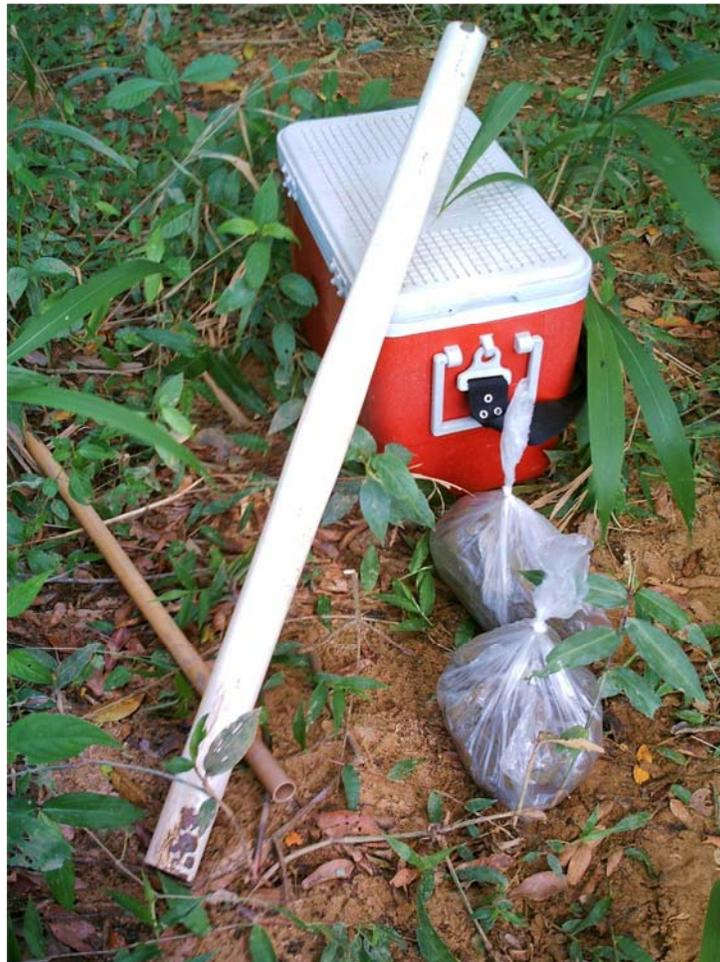
Figura 10: Materiais utilizados na coleta de sedimento. Tubos de PVC e caixa térmica para acondicionamento das amostras, já embaladas em sacos plásticos.
