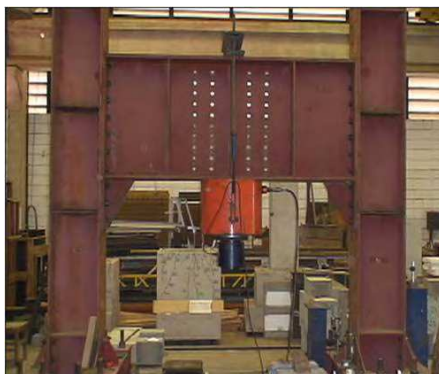
Figura 37 – Vista geral do pórtico metálico (Delalibera, 2006)
