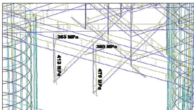
Figura 125 – Detalhe das tensões (em MPa) nos ganchos da armadura complementar passando pela projeção do pilar do modelo N3-BH60P35 \phi 32V100.
