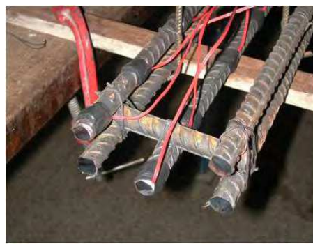
Figura 36 – Extensômetros na armadura principal de tração (Delalibera, 2006)
