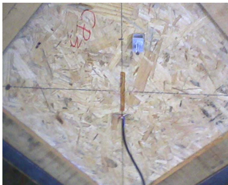
Figura 5-20 - Strain gages para aquisição da deformação.
