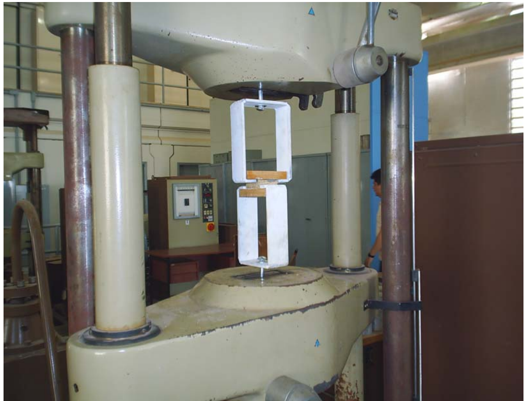
Figura 5-15 - Acoplagem à máquina de ensaio para ensaio de tração perpendicular às fibras.
