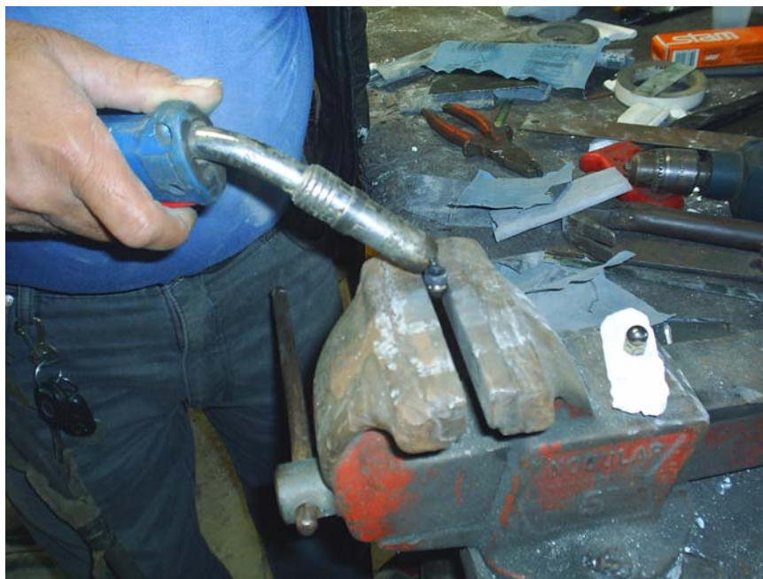
Figura 5-3 - Soldagem da esfera .
