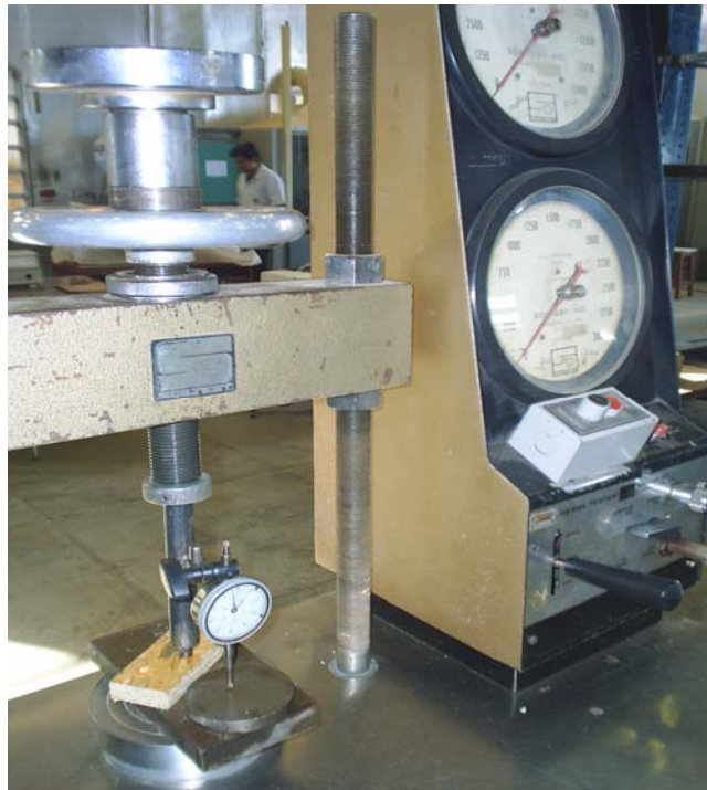
Figura 4-7 - Acoplagem do equipamento Janka na máquina universal.
