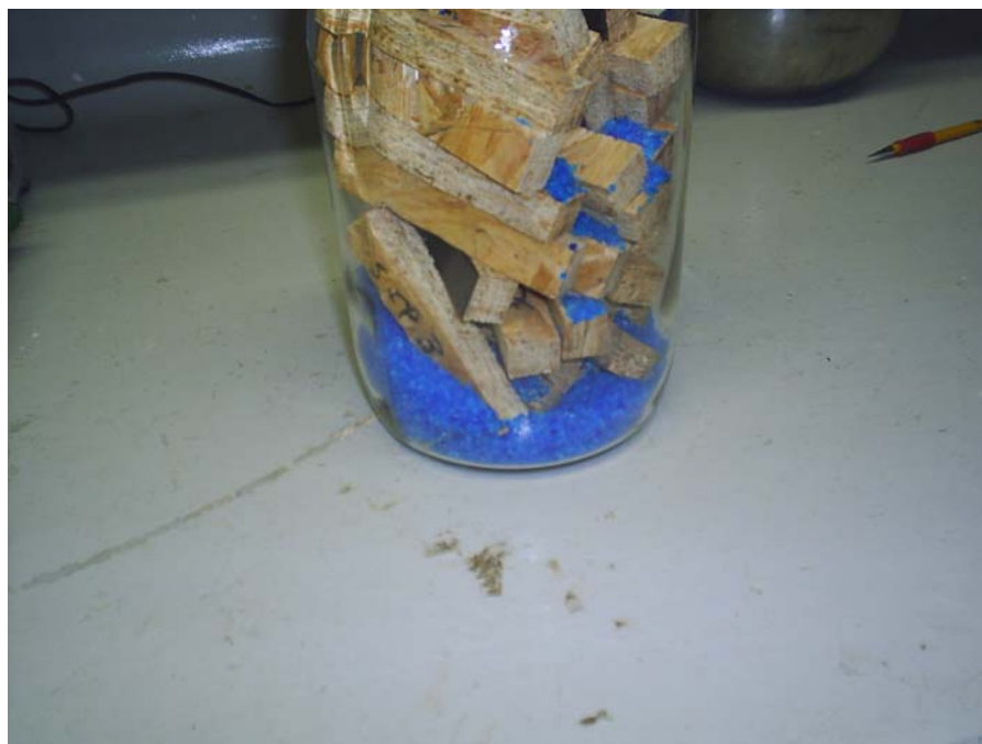
Figura 4-2 -Dessecador com desidratante, e indicador de saturação.
