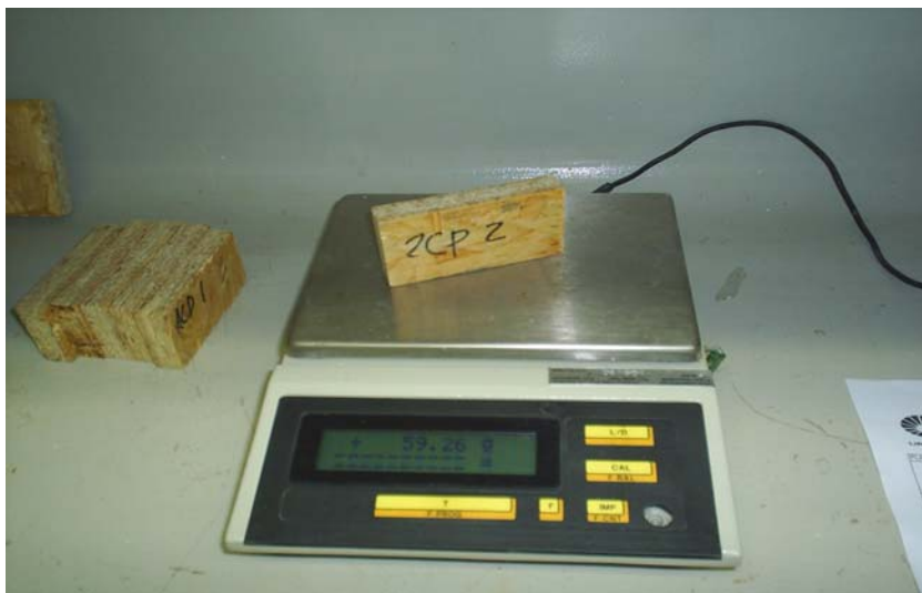
Figura 4-1 - Balança utilizada para determinação da massa constante.
