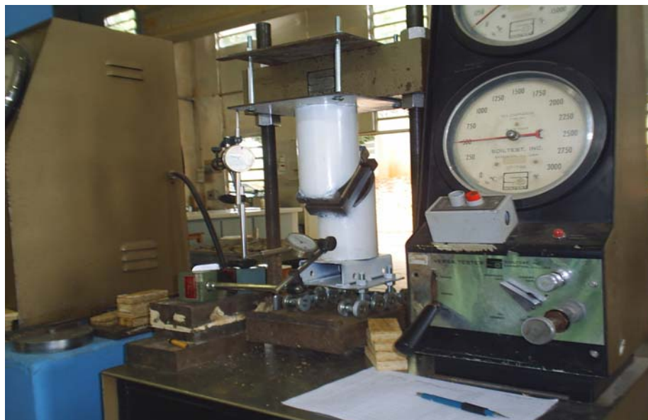
Figura 4-11 – Sistema para ensaio a compressão.
