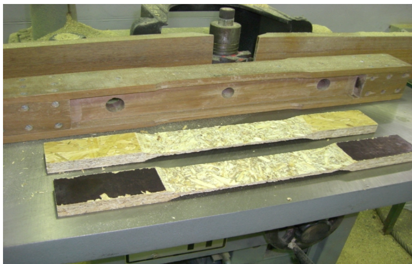
Figura 5-10 – Corpos-de-prova moldado conforme NBR 7190/97.
