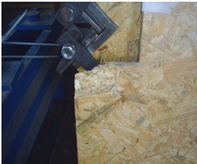
Figura 5-19- Esmagamento ocorrido nas bordas
