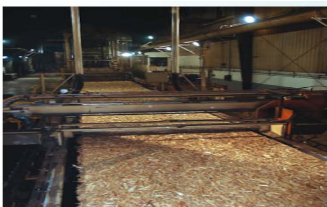
Figura 3-2 - Formação do colchão na linha de produção.
