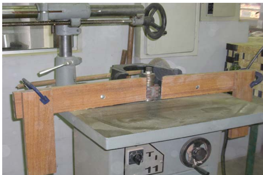
Figura 5-8 - Inserção de limitadores.
