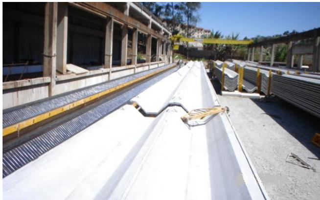
**Foto 3.** *Pista de Telhas protendidas de concreto.*
