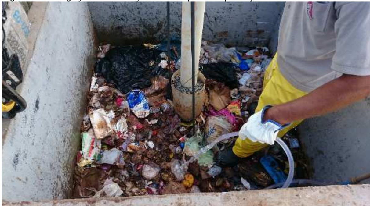
O processo de compactação repetiu-se até alcançar a quantidade de massa de RSU estabelecida. A quantidade de resíduo depositada nos lisímetros teve como base o primeiro lisímetro preenchido, o lisímetro nº6. No processo de preenchimento do lisímetro nº6, ao se atingir a altura máxima da camada de resíduo (prevista na Tabela 4-8), foi somada a massa total e estabelecido esse valor como base para os próximos lisímetros.
