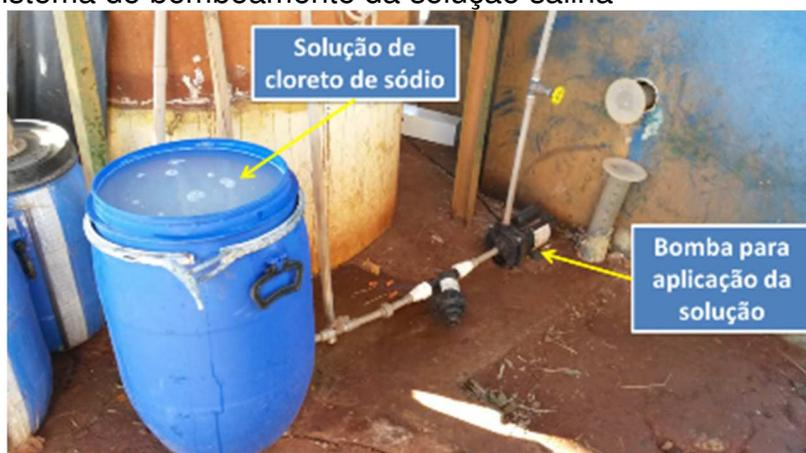
Inicialmente para preparar 120 L de solução de cloreto de sódio, foram utilizados 10 kg de sal de cozinha (concentração de 83 g/L). Posteriormente, a quantidade de sal foi aumentada para 24 kg de sal de cozinha para cada 120 L de solução (concentração de 200 g/L), com objetivo de potencializar o processo de inibição ou retardamento da biodegradação dos RSU.
