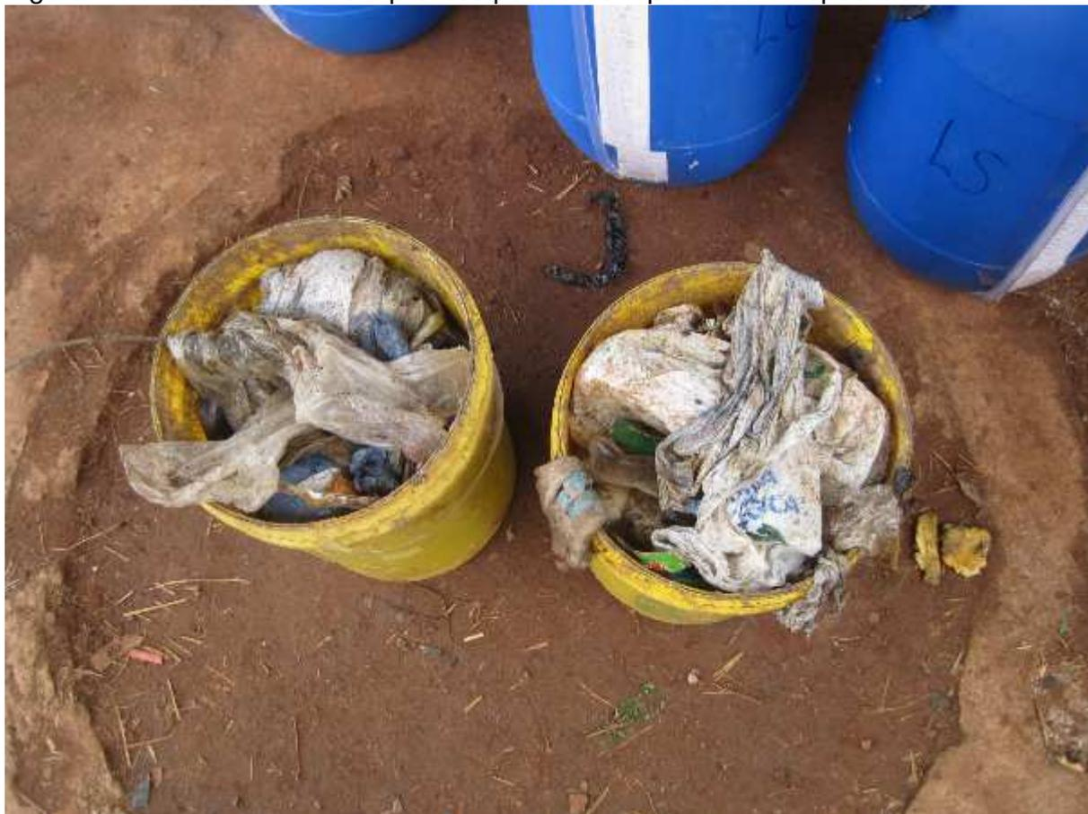
Os resíduos eram depositados em camadas de 12 cm e compactados com equipamento do tipo “sapo” por empresa especializada, com o objetivo de alcançar o peso específico de projeto,  $8,00 \text{ kN/m}^3$ . A espessura de 12cm foi adotada, durante o processo de preenchimento, após várias tentativas com diferentes medidas até atingir um valor mais próximo possível do peso específico de projeto, e uma boa logística do processo.
