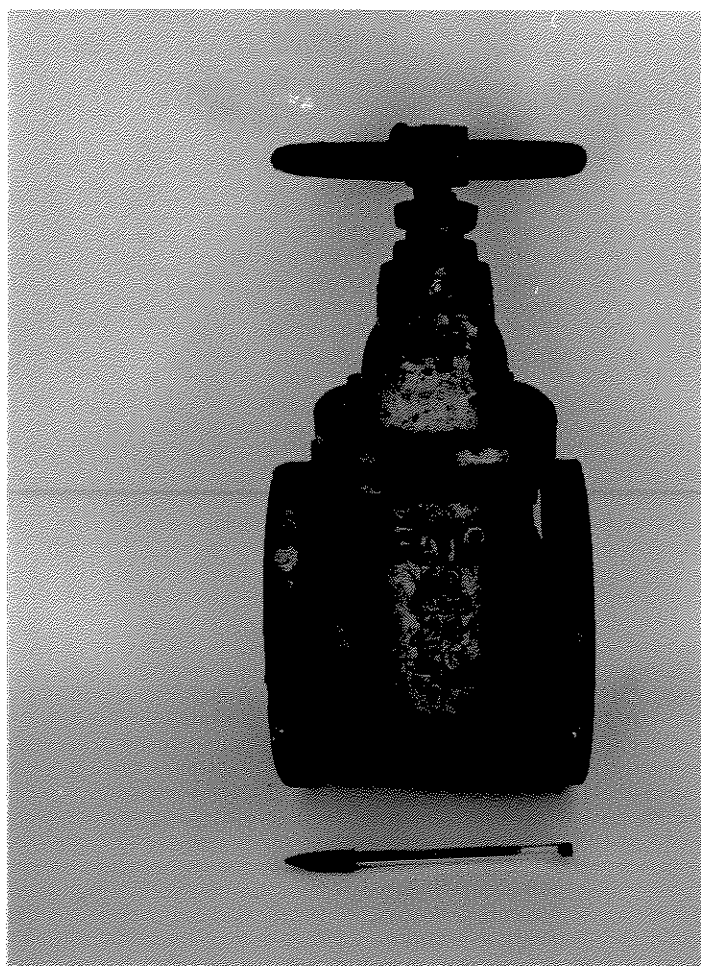
Foto 4.01. Registro de gaveta com flanges utilizado para o controle da vazão da mistura durante a primeira fase de ensaios.
