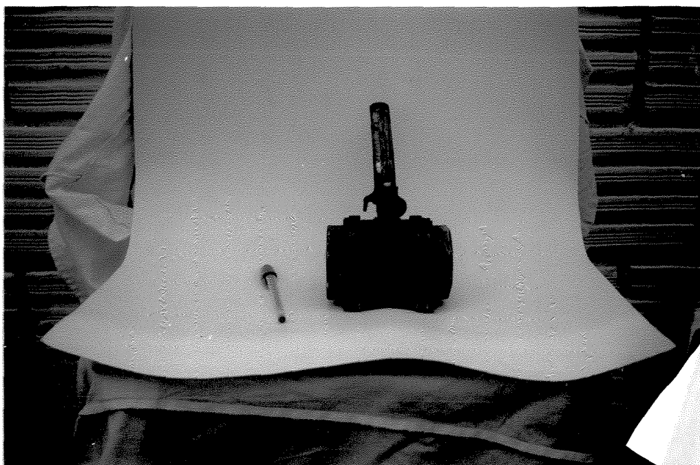
Foto 4.02. Válvula de pressão de 2" utilizada como "registro" de controle da vazão da mistura.
