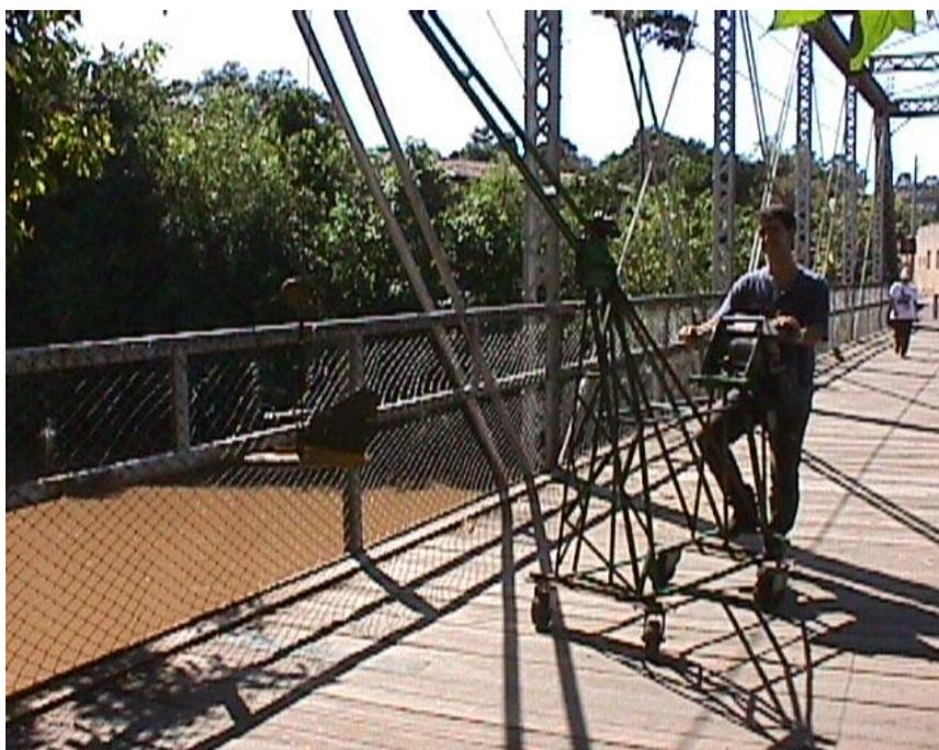
Figura 3.5 – Passarela de pedestres – seção de medição – Distrito de Sousas/ Campinas/SP e o suporte do amostrador AMS – 3.
