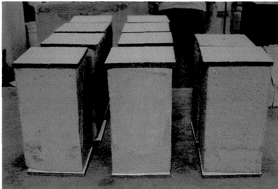
Figura 4.7 – Corpos-de-prova prismáticos nivelados por meio de “forro pacote”.
