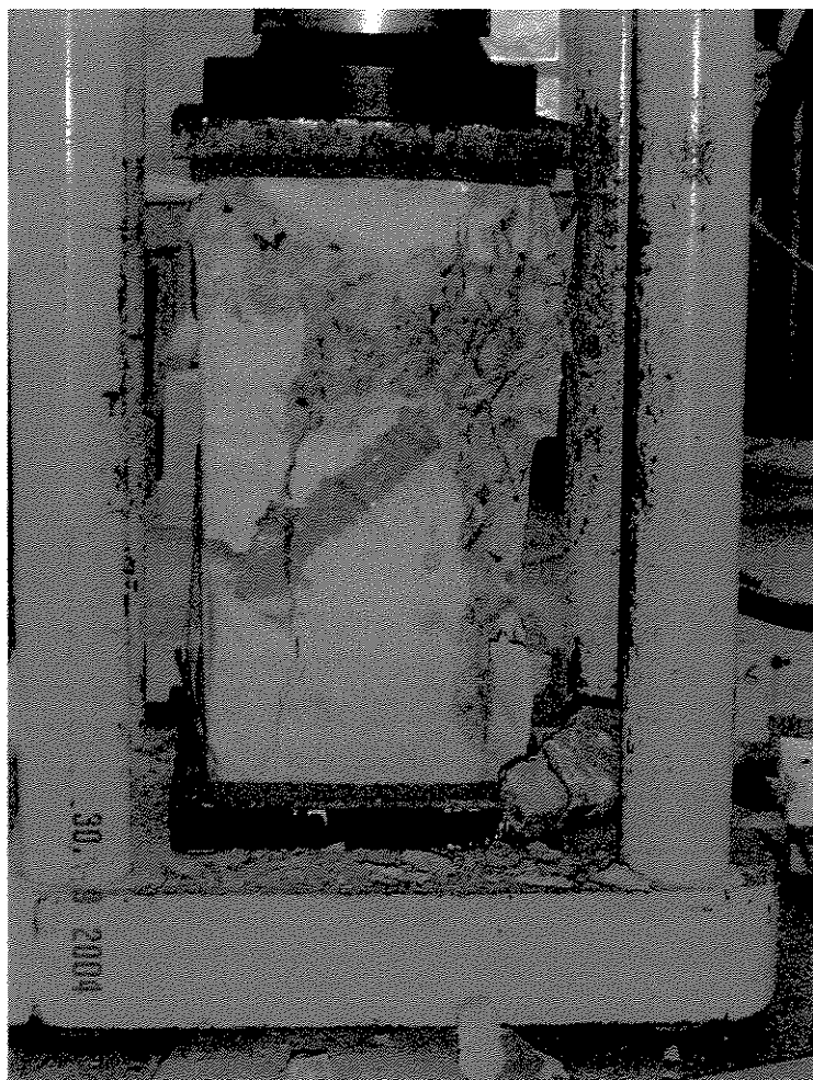
Figura 5.4 – Ruptura monolítica de prisma composto com ângulo da junta de 45^\circ , reparado com adesivo epóxi.
