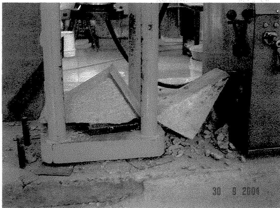
Figura 5.10 – Ruptura na junta de prisma composto com ângulo de 60^\circ e superfície lisa.
