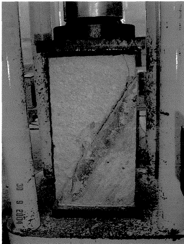
Figura 4.11 – Rompimento de corpo-de-prova prismático composto com junta de 60° (ruptura na junta de aderência).
