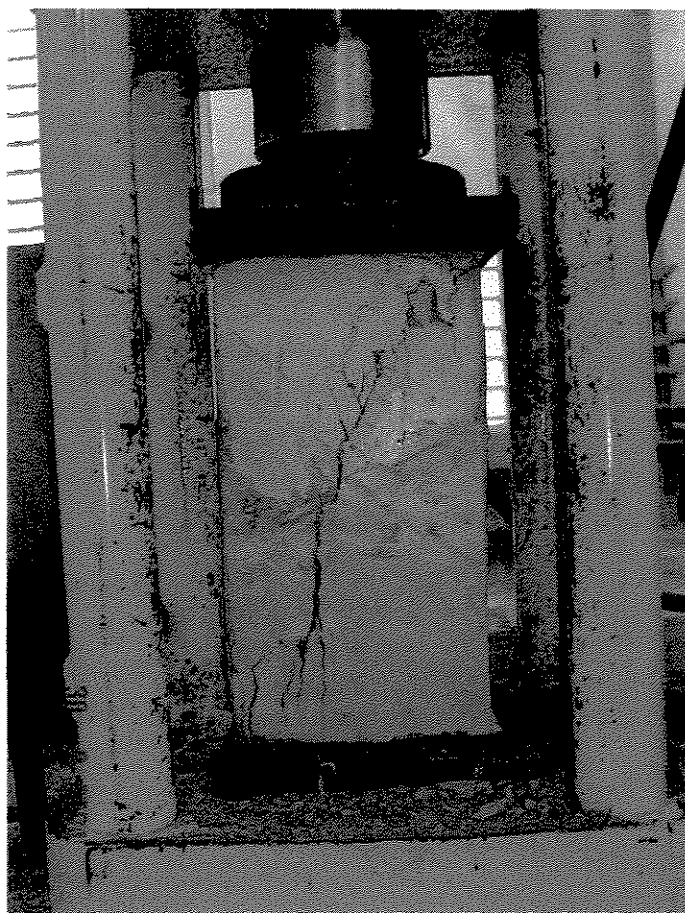
Figura 5.2 – Ruptura monolítica de prisma composto com ângulo da junta de 30°.
