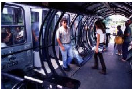
Figura 3.20: área interna da estação tubo - percebe-se o mesmo nível entre a estação e o veículo. Fonte: http://www.curitiba.pr.gov.br
