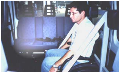
Figura 6.4: Banco traseiro para três pessoas não oferece conforto e segurança aos usuários por ser estreito e duro.
