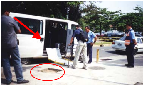
Figura 6.2 - Falta corrimão no elevador da Van e buraco no passeio próximo ao embarque
