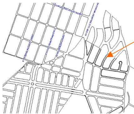
6.12 - Distorções entre os encaixes entre as quadras. O encaixe de atualizações posteriores a construção da base não segue o mesmo padrão. O traço mais forte, parte atualizada, com consideração dos passeios
