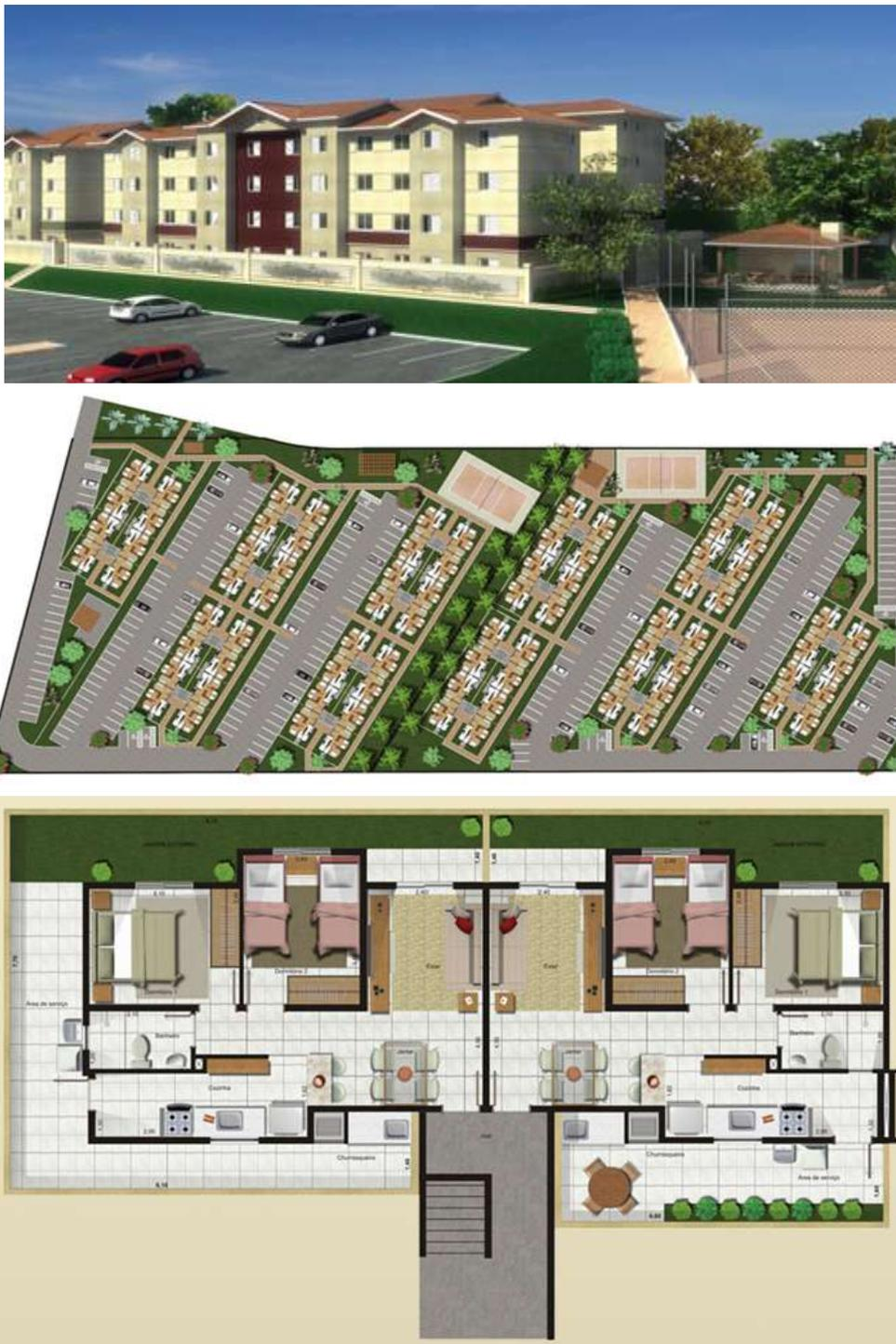
FIGURA 51: apartamentos em construção, com 44,60 m<sup>2</sup> fachada, implantação e planta baixa (fonte: <http://www.mestraengenharia.com.br/>).
