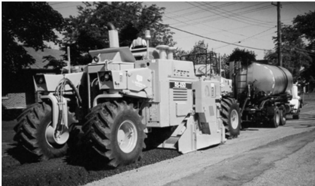
**Figura 5.10 – Reciclagem profunda com incorporação de emulsão asfáltica.**
