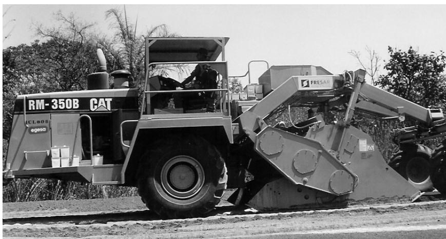
Figura 7.1 – Máquina recicladora de pavimentos CAT RM 350
