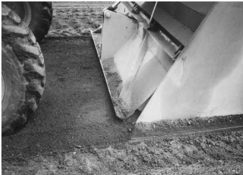
**Figura 6.29 – Abertura da tampa traseira (*scraper*) da câmara de mistura**
