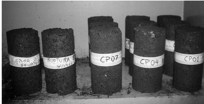
**Figura 7.7 – Cura dos corpos-de-prova na câmara úmida**
