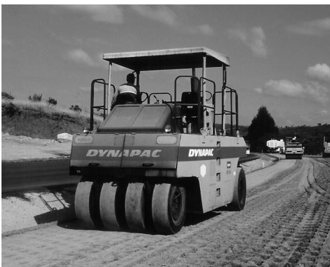
**Figura 6.14 – Rolo compactador de pneus.**
