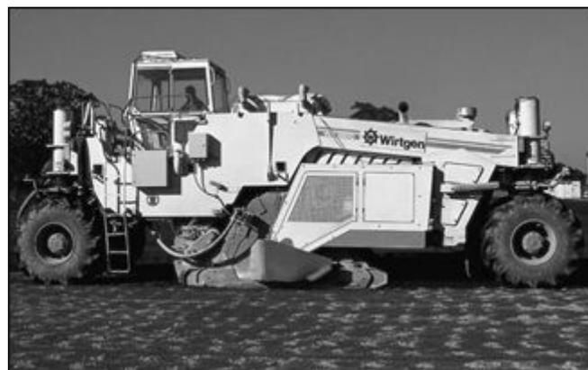
**Figura 6.4 – Recicladora Wirtgen WR 2500 K**
