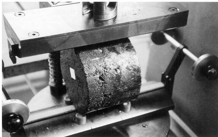
**Figura 5.13 – Corpo-de-prova sendo submetido ao ensaio de ITS**
