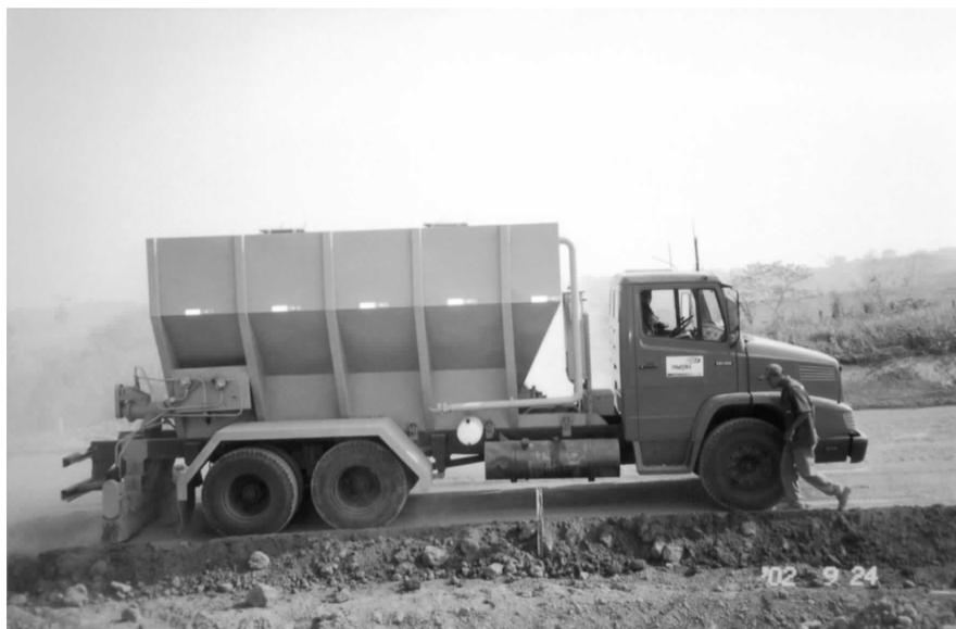
**Figura 5.7 – Espalhador de agente estabilizante na forma de pó.**
