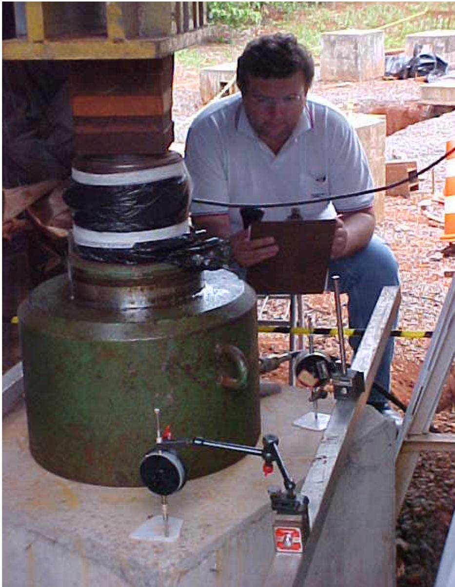
**Figura 3.53** – Leitura dos relógios para controle de recalques.
