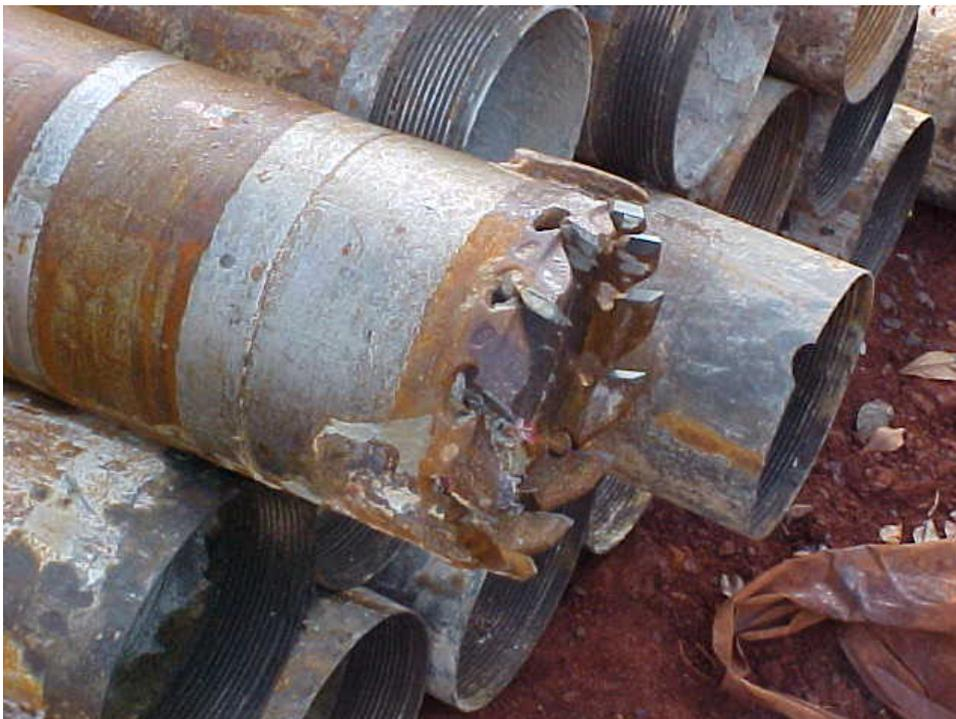
**Figura 3.33** – Tubos de revestimento (detalhe da sapata de perfuração) .
