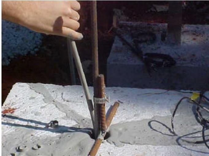
**Figura 3.24** – Detalhe da imobilização da barra para aguardo de ganho de resistência da argamassa.
