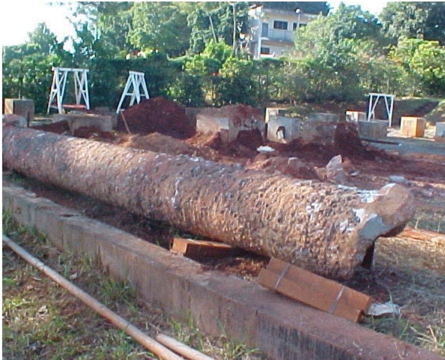
**Figura 6.3** – Vista da ponta e do trecho do fuste correspondendo à segunda camada do solo.
