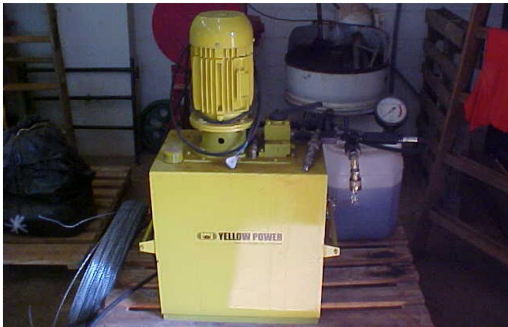
**Figura 3.51** – Bomba elétrica para alimentação do macaco.
