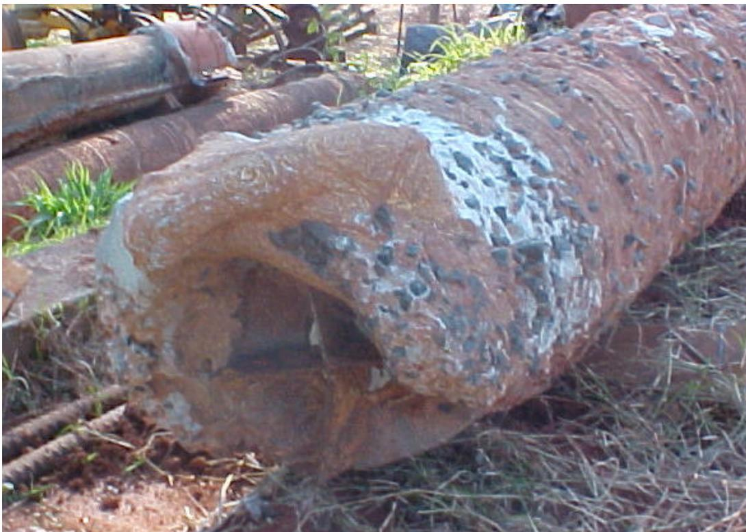
**Figura 6.4**– Vista da ponta da estaca.
