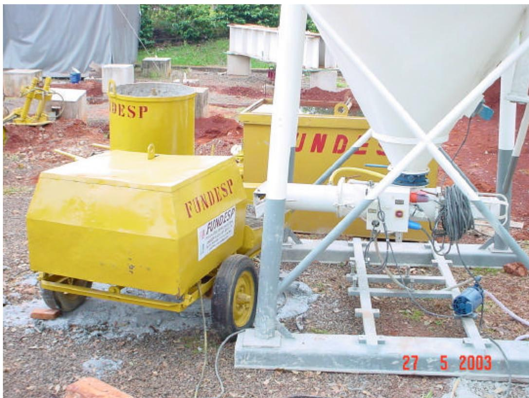
**Figura 3.31** – Bomba para injeção da argamassa.
