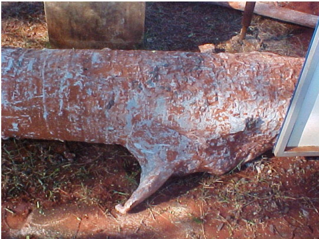
**Figura 6.9** – Detalhe do trecho de fuste correspondendo à primeira camada.
