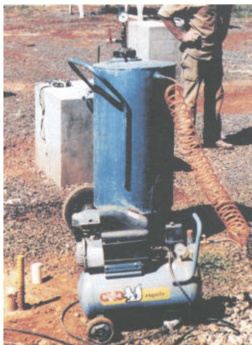
**Figura 3.23**-Reservatório de nata e compressor de ar.
