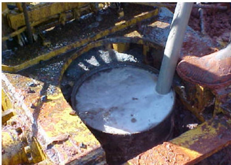
**Figura 3.42** – Água próxima à boca do tubo de revestimento.
