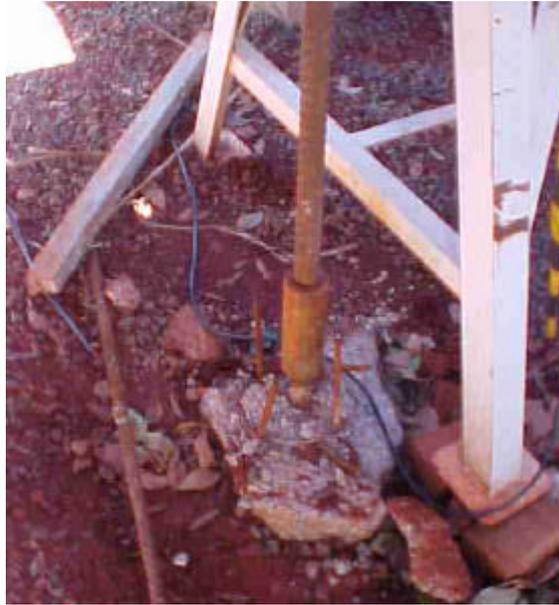
**Figura 3.15** – Estacas de reforço para o sistema de reação .
