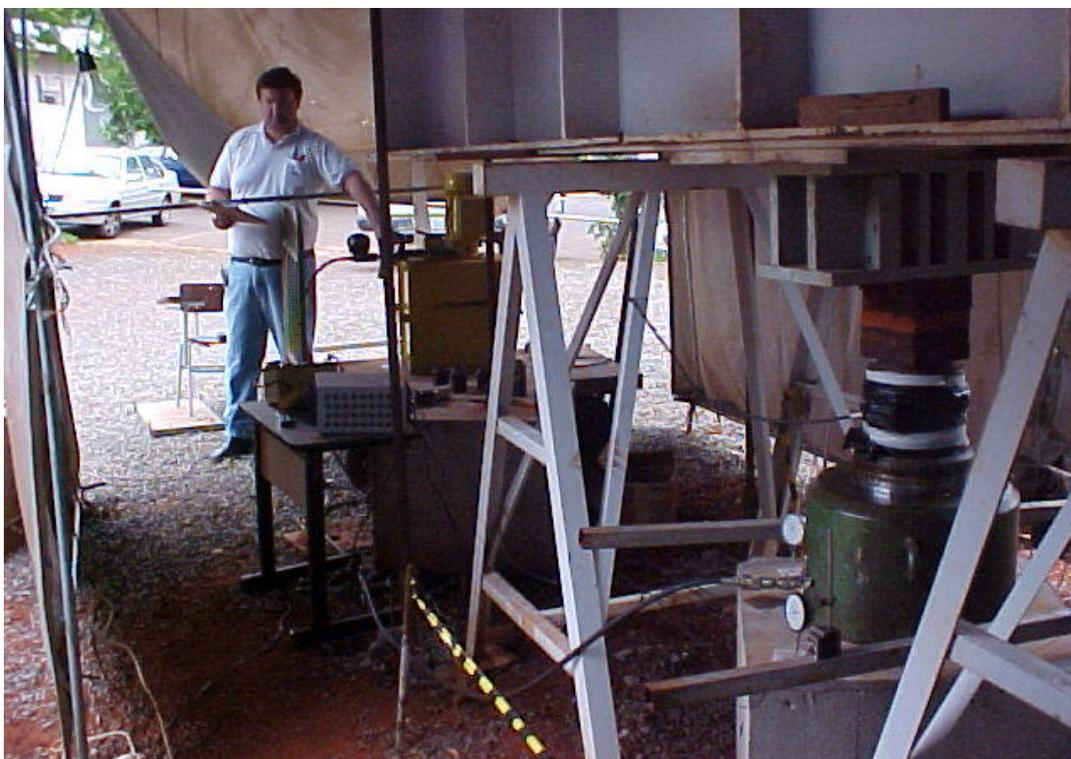
**Figura 3.52** – Controle manual da pressão na bomba elétrica.
