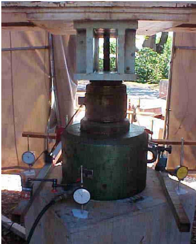
**Figura 3.50** – Macaco (verde), célula de carga, vigota, relógios (recalque) e vigas de referência.
