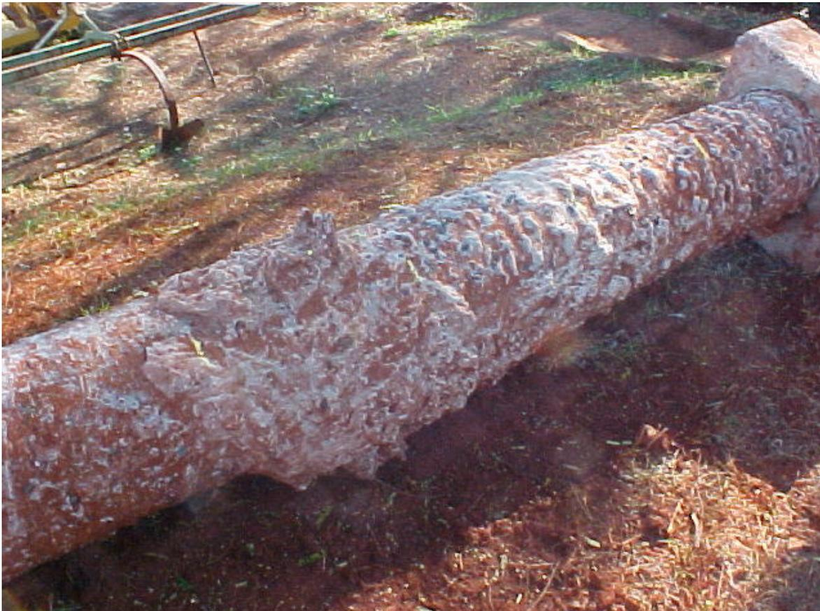
**Figura 6.7** – Irregularidades do fuste e variação de diâmetro na região da primeira camada do solo.
