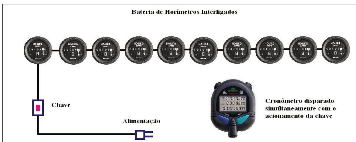
Figura 27 – Esquema da instalação de ensaio dos horímetros
