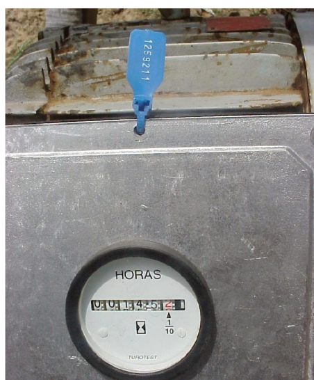
Figura 30 - Lacres para garantir a inviolabilidade do sistema
