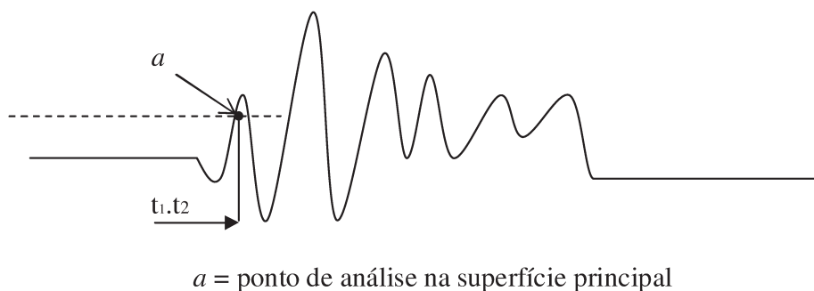
Figura 4 – Princípio de medição utilizando o método “Superfície Principal”
