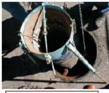
Figura C.2 - Insuflador de ar – adaptado MTE 2003
