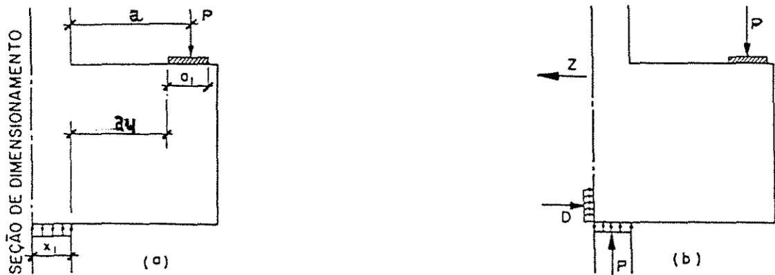
Fig. 3.28: a) Definição da região do consolo e secção de dimensionamento
